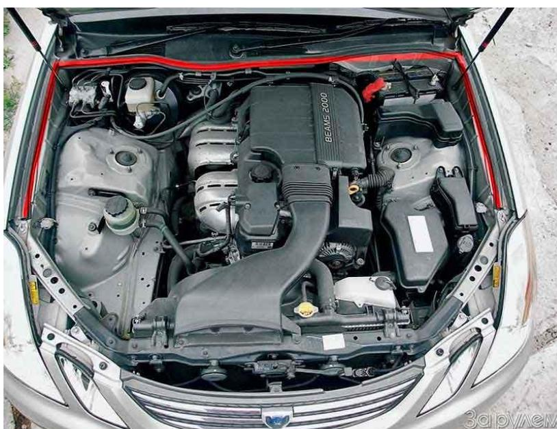
Рис. 17. Воздуховод двигателя как пример телесной трассировки
