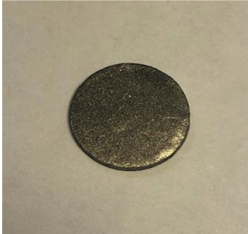
Рисунок 5.4 – Экспериментальный образец для исследования внеплоскостной температуропроводности и теплопроводности
