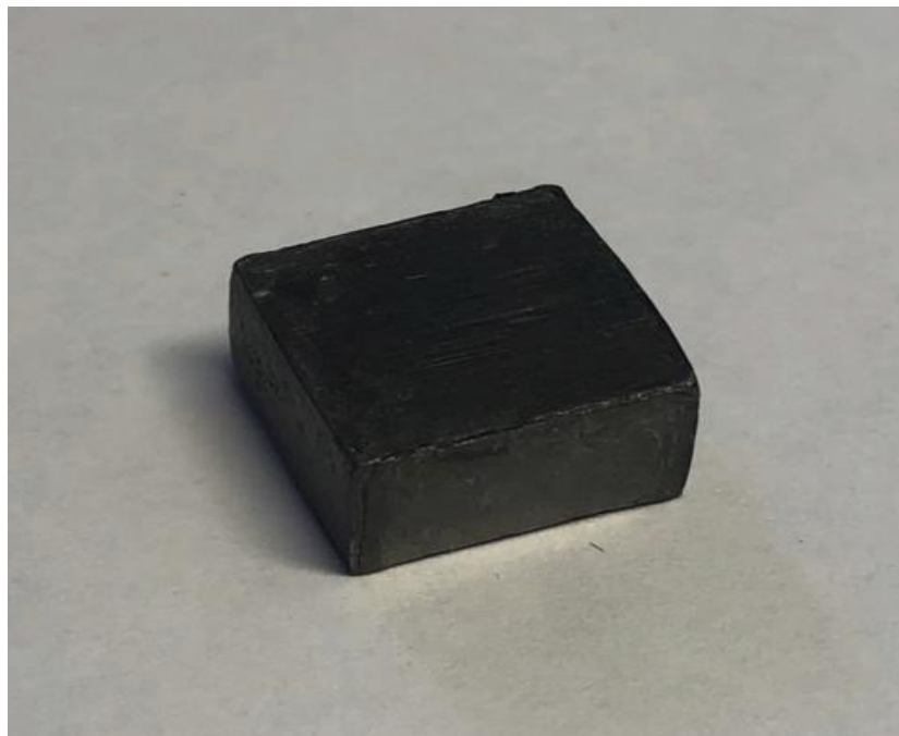
Рисунок 5.5 – Экспериментальный образец для исследования плоскостной температуропроводности и теплопроводности
