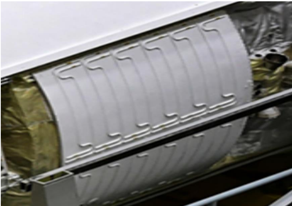
Рисунок 6.13 – Радиационный теплообменник на основе тепловых труб
