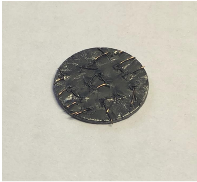
Рисунок 5.11 – Опытный образец гибридной структуры в виде диска, прошитый в плоскости медной проволокой в виде “скрепок”
