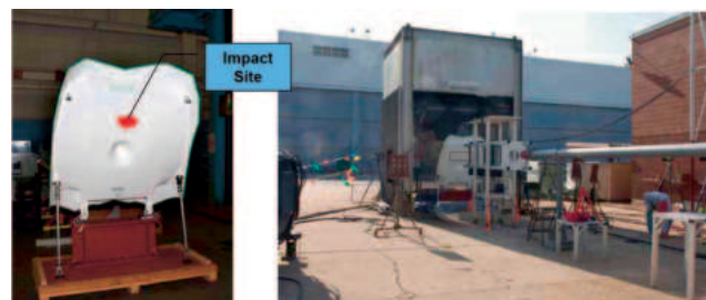
Рис. 3. Место удара птицы на подъемной крышке вентилятора и общий вид стенда с пневмопушкой
