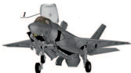
Рис. 1. Крышка вентилятора самолета F35
