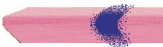
Рис. 9. Удар птицы по предкрылку ( \tau = 1,5 мс)
