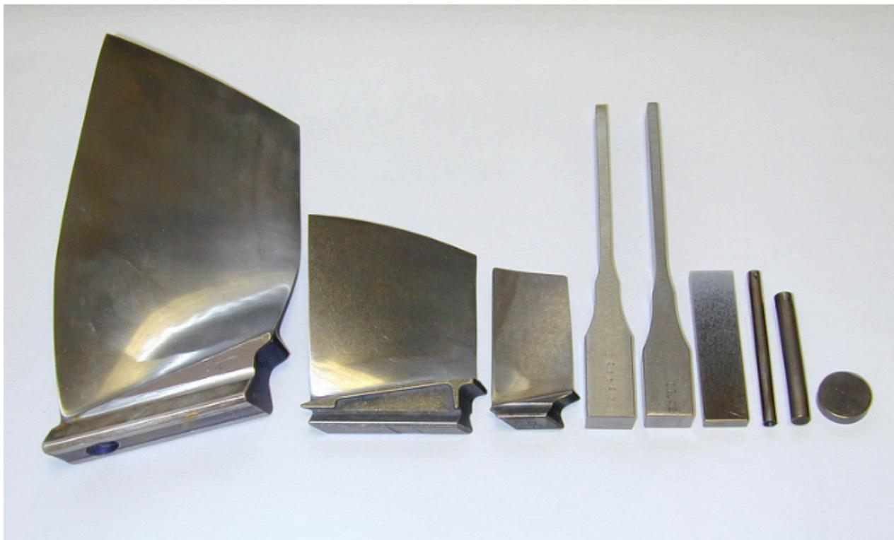
**Рисунок 2 - Внешний вид исследуемых образцов (лопатки компрессора ГТД РД33 из титановых сплавов и стали для изучения физико-химического состояния поверхностных слоев материала, а также образцы для проведения усталостных, коррозионных и эрозионных испытаний).**
