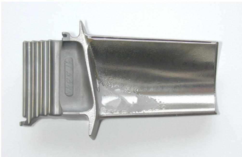
Рисунок 20 - Внешний вид серийной лопатки из сплава ЖС26НК с вакуумно-дуговым покрытием СДП-2, облученной электронным пучком (отслоение покрытия на корыте и в зоне входной кромки).
