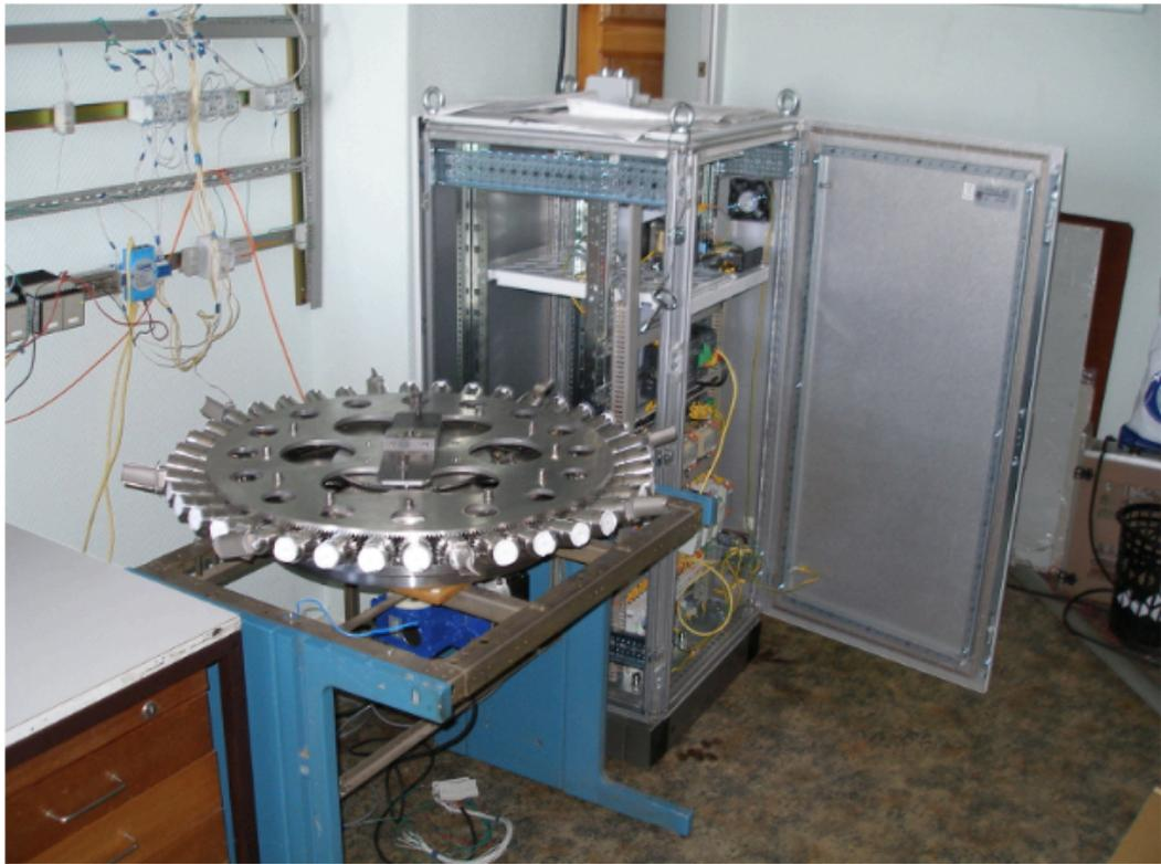
Рисунок 5 - Внешний вид устройства для закрепления лопаток в установке «ГЕЗА-ММП».
