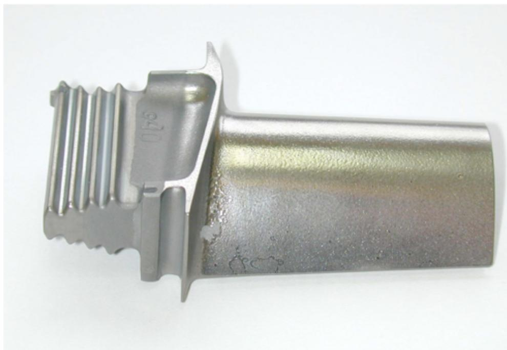
Рисунок 21 - Внешний вид серийной лопатки из сплава ЖС26НК с вакуумно-дуговым покрытием СДП-2, облученной электронным пучком (отслоение покрытия на спинке в зоне выходной кромки и в окрестности перехода спинки к замку).
