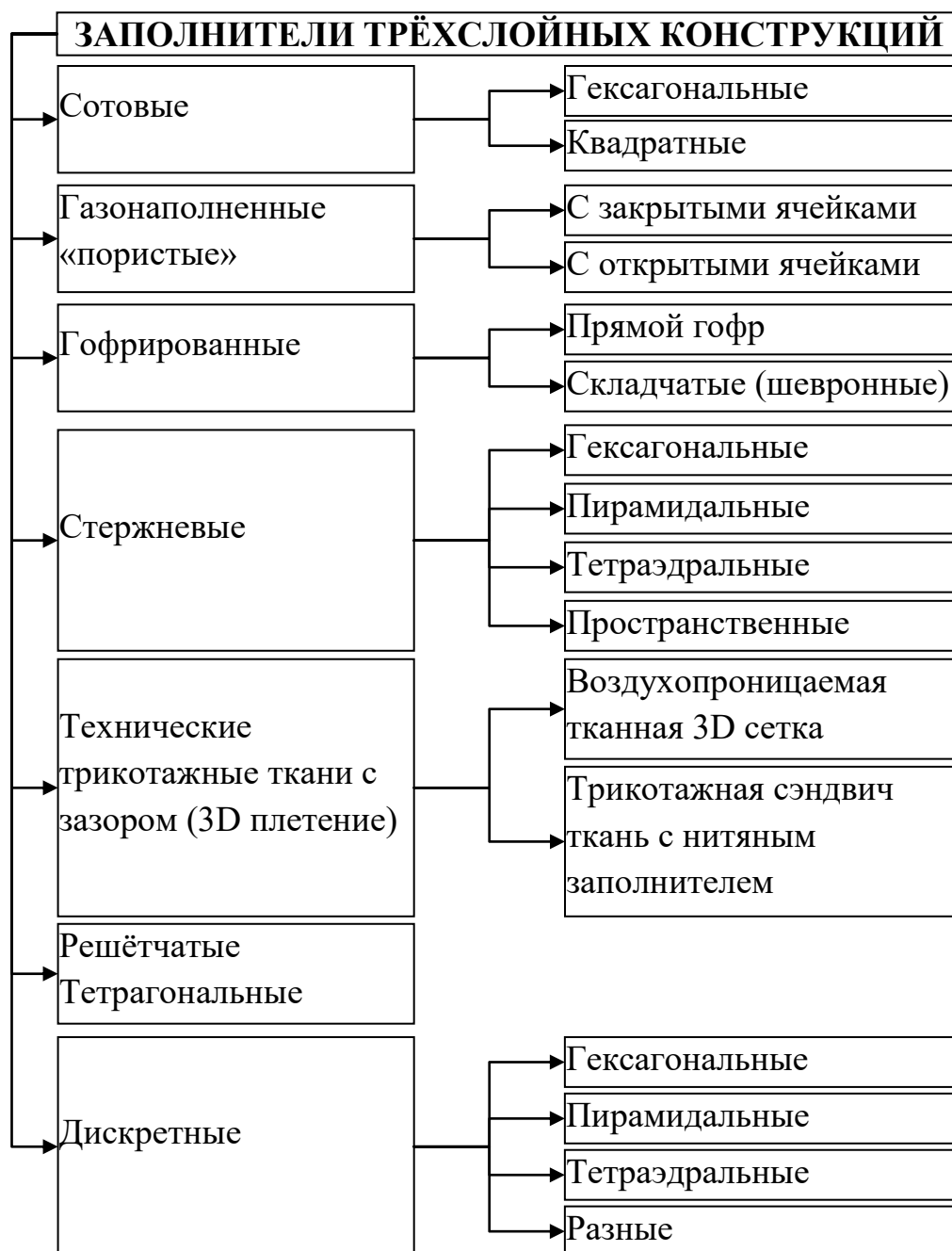
Рисунок 2. Классификация структур наполнителей трёхслойных конструкций.
