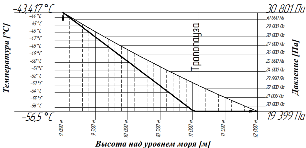
Рисунок 4. График изменения давления и температуры в зависимости от высоты на высотах от 9000 м до 12000 м (ГОСТ 4401-81[2])
