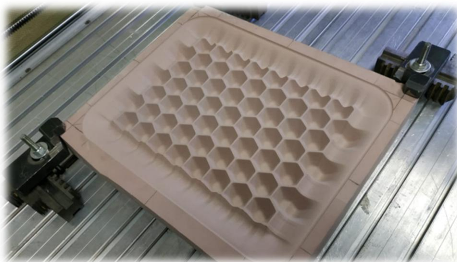
Рисунок 81. Чистовая обработка оснастки
