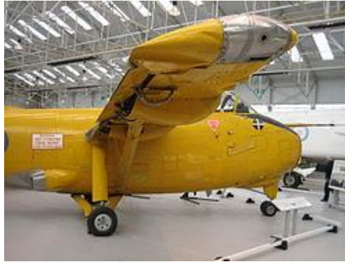
Рисунок 44. Экспериментальный британский самолёт Hunting H.126, предназначенный для испытаний реактивных закрылков
