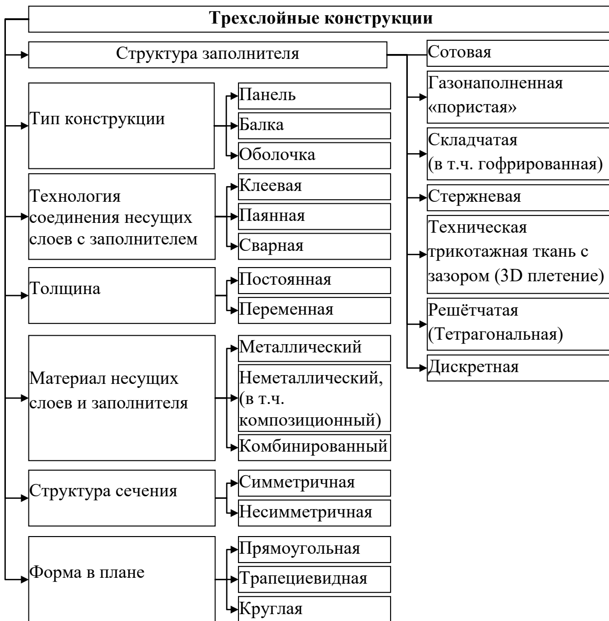
Рисунок 13. Классификация трёхслойных конструкций.
