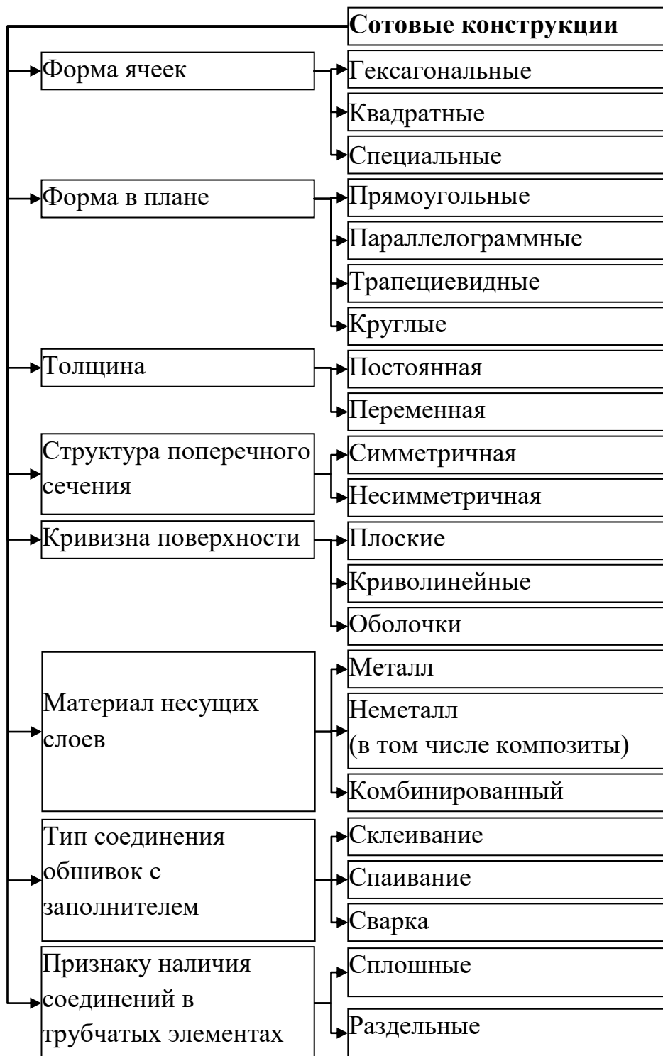
Рисунок 14. Классификация сотовых конструкций.
