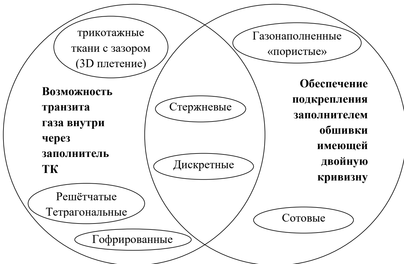
Рисунок 40. Соответствие требованиям к облику конструкции трёхслойного закрывка с возможностью управления пограничным слоем заполнителей различных структур.
