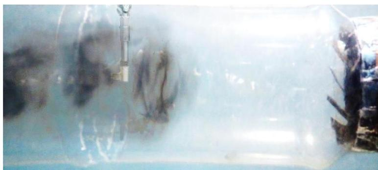
Рис. 3 Исследование образования топливовоздушной смеси на модели импульсной камеры сгорания при расположении форсунки на удалении более двух диаметров обратного клапана
