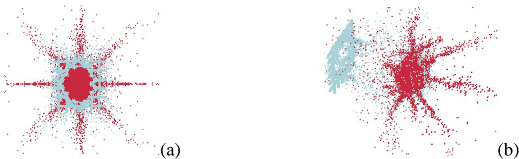
Рис. 14 Численное моделирование нормального удара сферического алюминиевого ударника по стальной сеточной преграде со скоростью 3 км/с;  $d_p=6.35$  мм, параметры сетки:  $l_a \times d_w = 2.0$  мм $\times$ 0.6 мм. Ударник нацелен на центр ячейки сетки. Рисунки соответствуют моменту времени 10 мкс. Левый рисунок показывает вид сверху
