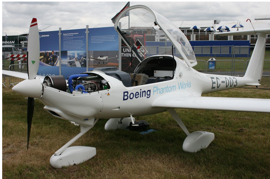
Рисунок 1.10 – Boeing Fuel Cell Demonstrator (двухместный аэроплан Diamond Aircraft Industries)
