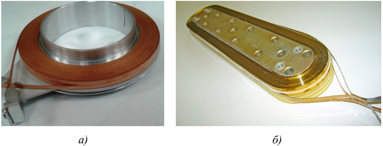
Рисунок 4.1 – Катушки индуктивности на основе ВТСП лент 2-го поколения:
