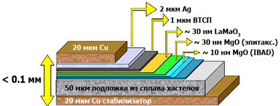
Рисунок 1.3 – Структурная схема композитного ленточного ВТСП провода 2-го поколения
