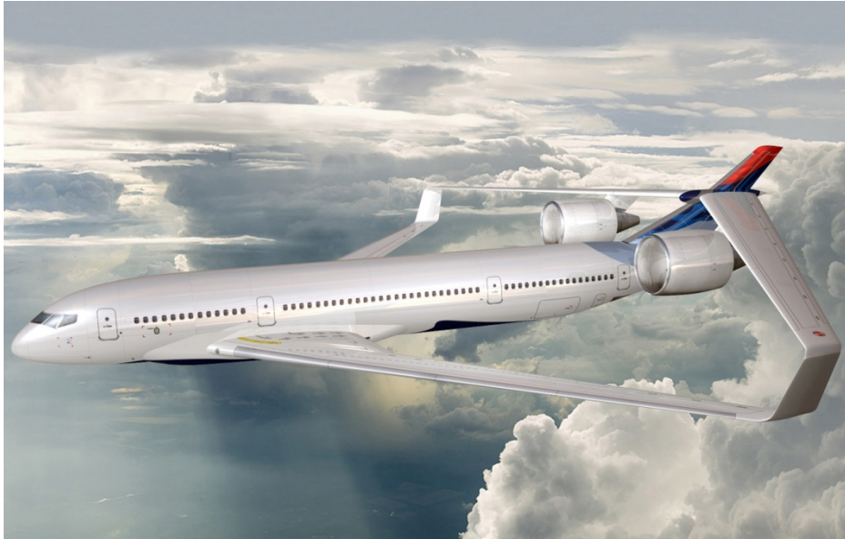
Рисунок 1.9 – Концепт «Box Wing Jet» с замкнутой конструкцией крыла
