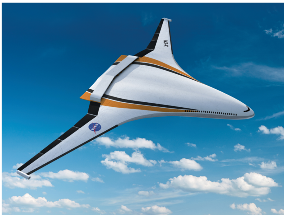
Рисунок 1.6 – Гибридный самолет NASA N3-X
