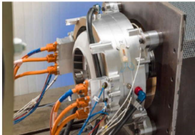
Рисунок 1.14 — Электродвигатель мощностью 261 кВт ( Siemens )
