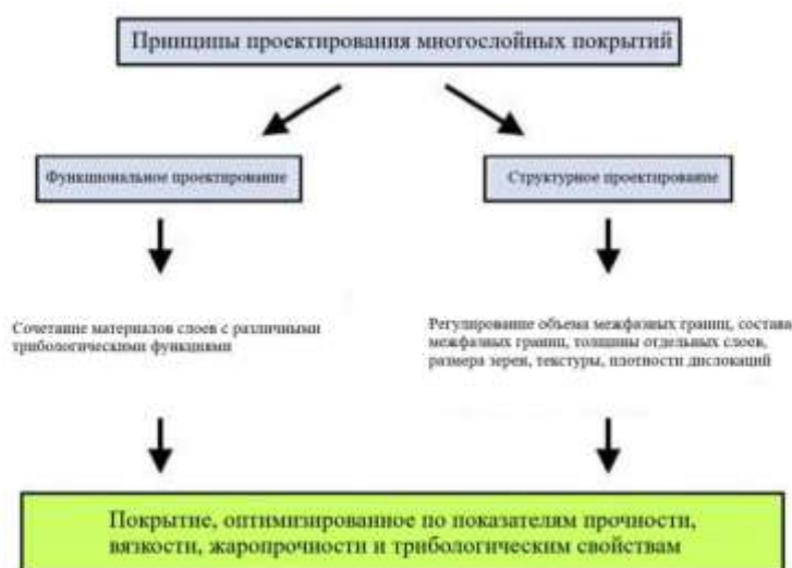
Рисунок 1.3 – Принципы проектирования многослойных покрытий [12].
