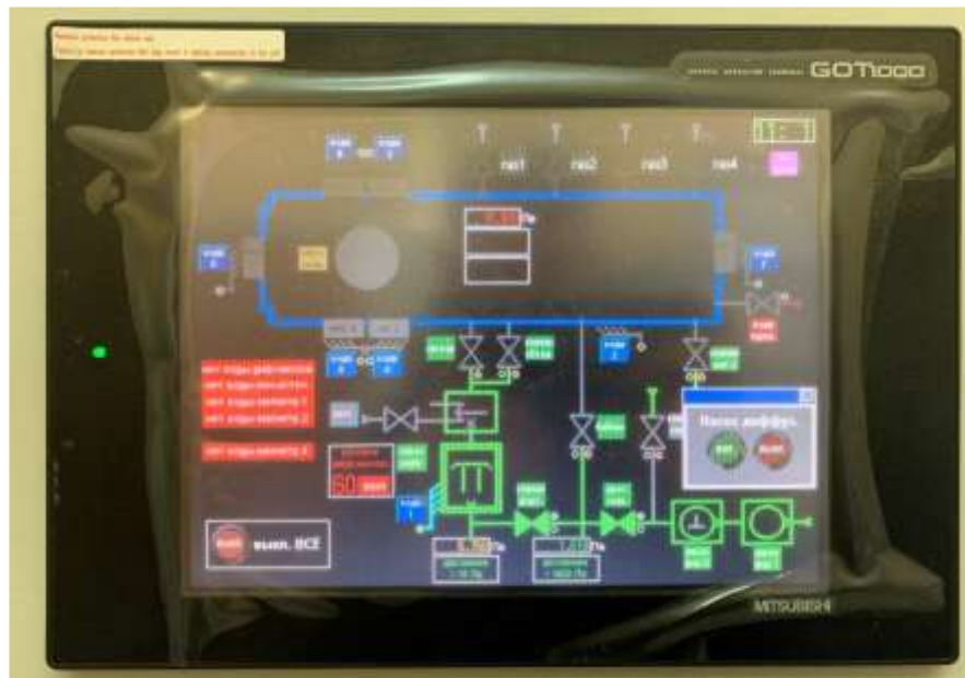
Рисунок 2.4 – Общий вид панели управления вакуумной системой установки УВМ-700-4М
