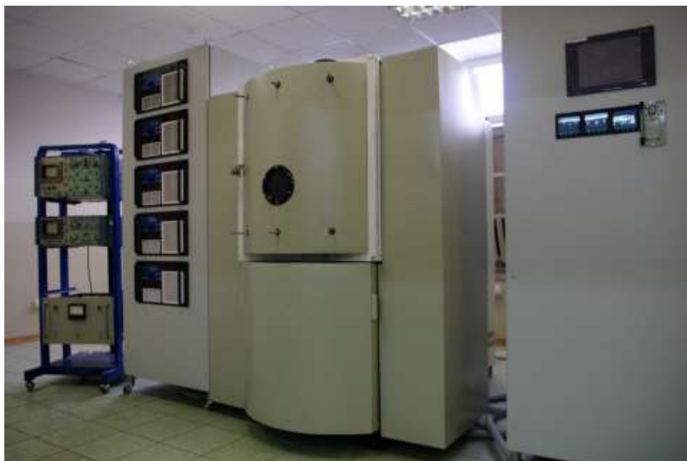
Рисунок 2.1 – Установка магнетронного напыления с замкнутым полем УВМ-700-4М.
