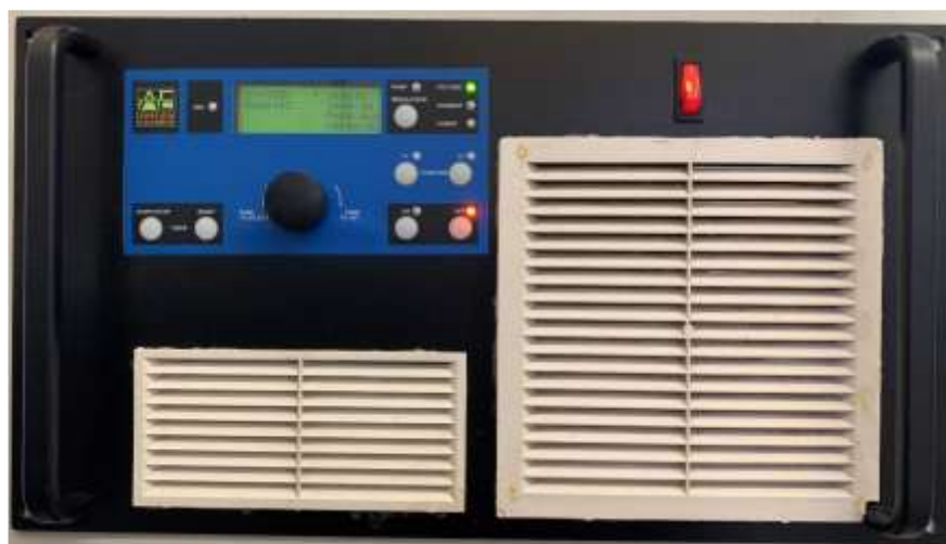
Рисунок 2.3 – Общий вид источника питания магнетрона APEL-SB-650-12 установки УВМ-700-4М.
