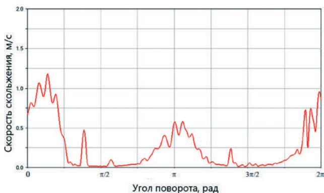
Рис. 6. Изменение скорости скольжения на внутренней базовой дорожке качения за один оборот сепаратора в том же варианте расчета, что и на рис. 1 и 2
