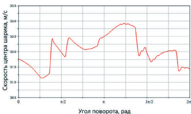
Рис. 5. Изменение линейной (орбитальной) скорости центра шарика за один оборот сепаратора в том же варианте расчета, что и на рис. 1 и 2
