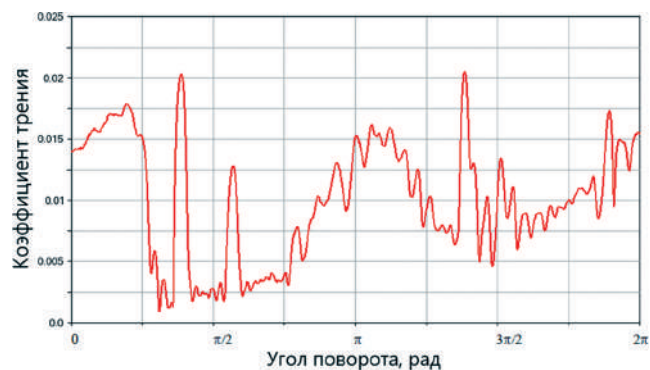
Рис. 7. Изменение коэффициента трения на внутренней базовой дорожке качения за один оборот сепаратора в том же варианте расчета, что и на рис. 1 и 2
