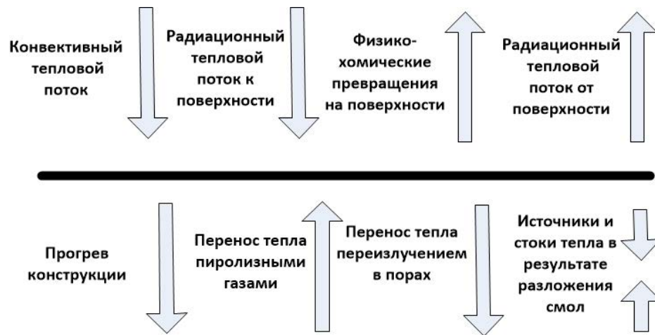
Рисунок 1.1 — Баланс энергии при разрушении пористого неоднородного материала.
