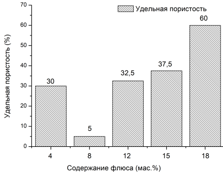
Рисунок 5.14 – Зависимость удельной пористости в цилиндрических соединениях от содержания флюса в паяльной смеси
