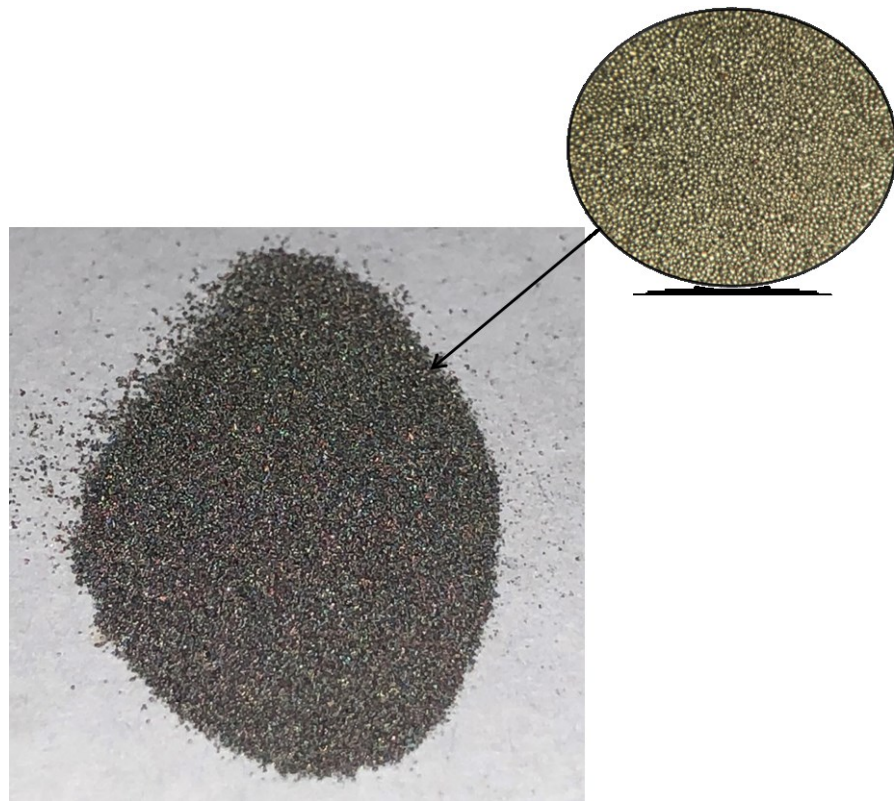
Рисунок 5.3 – Сферический порошок припоя МНМц9-23,5, полученный методом распыления газом
