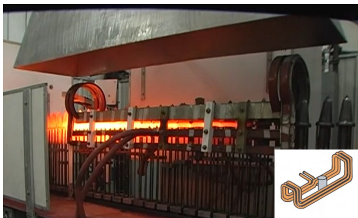
Рисунок 1.7 – Конвейерная линия пайки резцов со схематичным изображением индукционного нагревателя [43]
