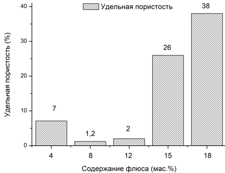
Рисунок 5.15 – Зависимость удельной пористости в цилиндрических соединениях с фаской от содержания флюса в паяльной смеси
