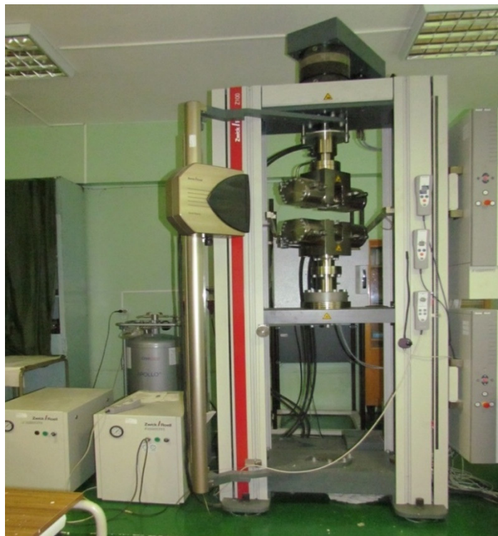
Рис. 2.2. Испытательная машина Zwick-Z100 с двумя приводами
