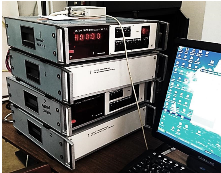
Рис. 2.4. Тензостанция СИИТ-4, подключенная к компьютеру
