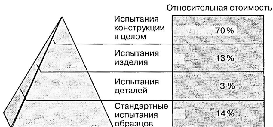
Рис 2.1. Сопоставление этапов сертификации материалов по числу испытаний и их относительной стоимости [118]
