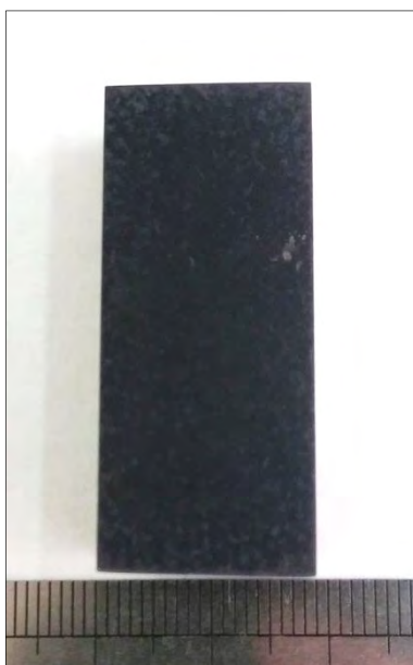
Рисунок 3.22 – Внешний вид образцов из сплава ВТ6 с микро-дуговым оксидным покрытием после МДО в растворе \text{Na}_2\text{SiO}_3 + \text{NaOH} в течение 5 минут и последующего вакуумного отжига при 800^\circ\text{C} в течении 1 часа
