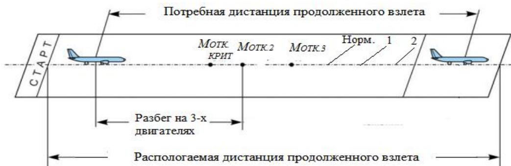
Рис. 14. Схема продолженного взлета при отказе двигателя на скорости менее  $M_{\text{отк.крит}}$
