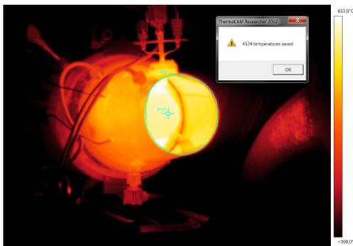
Рисунок 12. Пример выделения области сопла для экспорта температур
