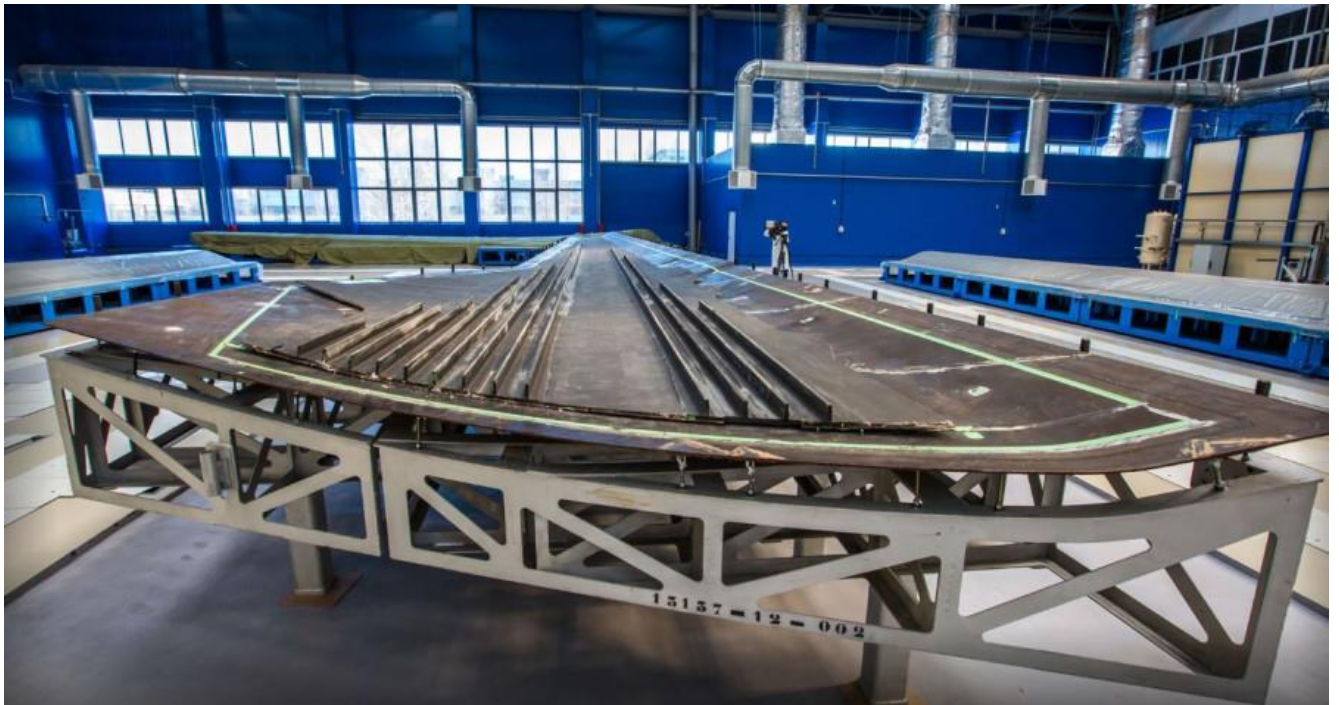
Рисунок 3 – Стрингерная панель из ПКМ
