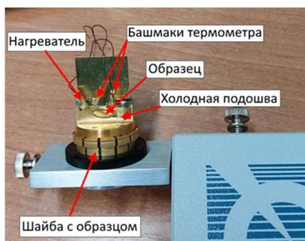
Рис. 2. Вставка в ТТО для измерения тепловых свойств материалов
