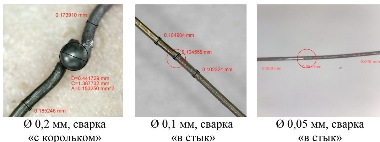
Рис. 5 Целевые термопары при увеличении
