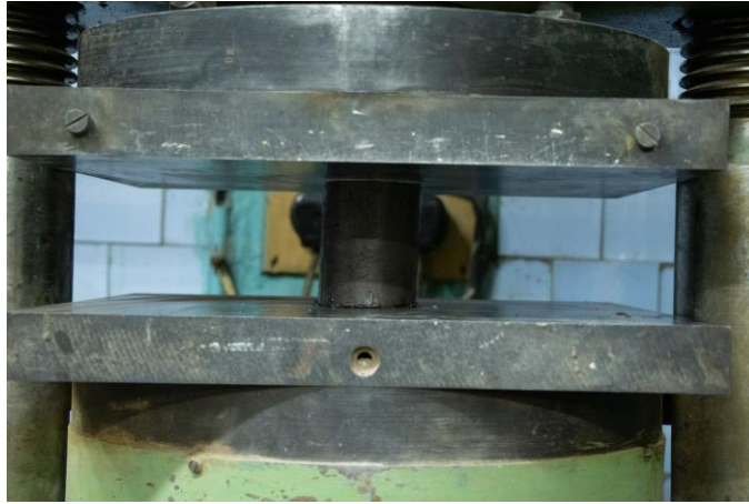
Рисунок 4.20 – Фото испытания короткого трубобетонного образца на осевое сжатие для определения продольной жесткости.
