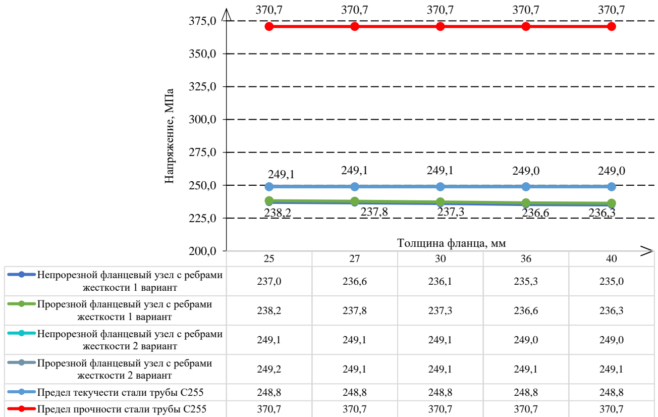
Рисунок 4.11 - Зависимость напряжения в пластине фланца от его толщины
