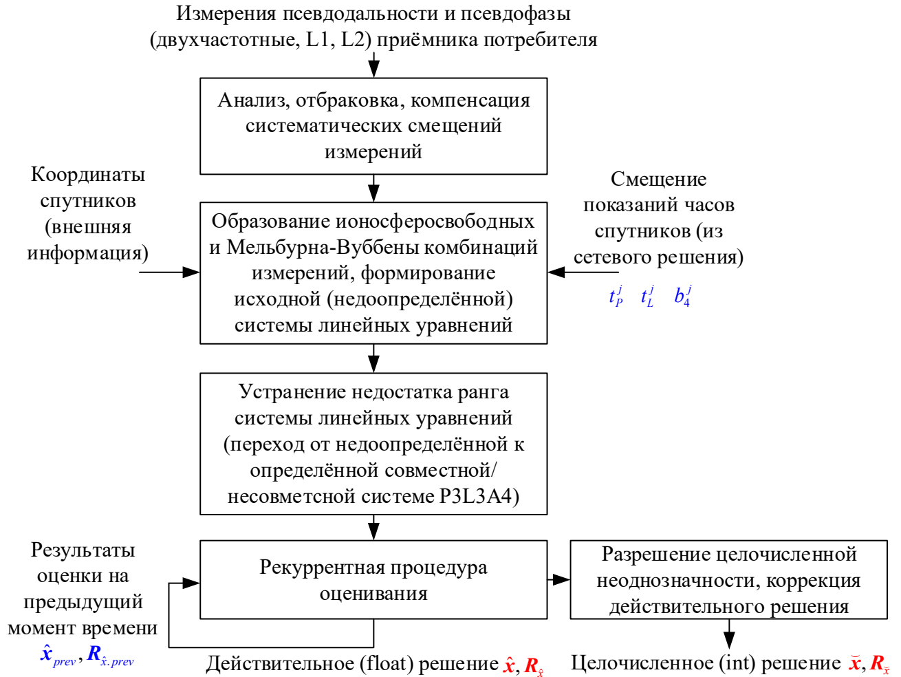
Рисунок Б.1 – Укрупнённая блок-схема алгоритма решения пользовательской задачи целочисленного ВАМО
