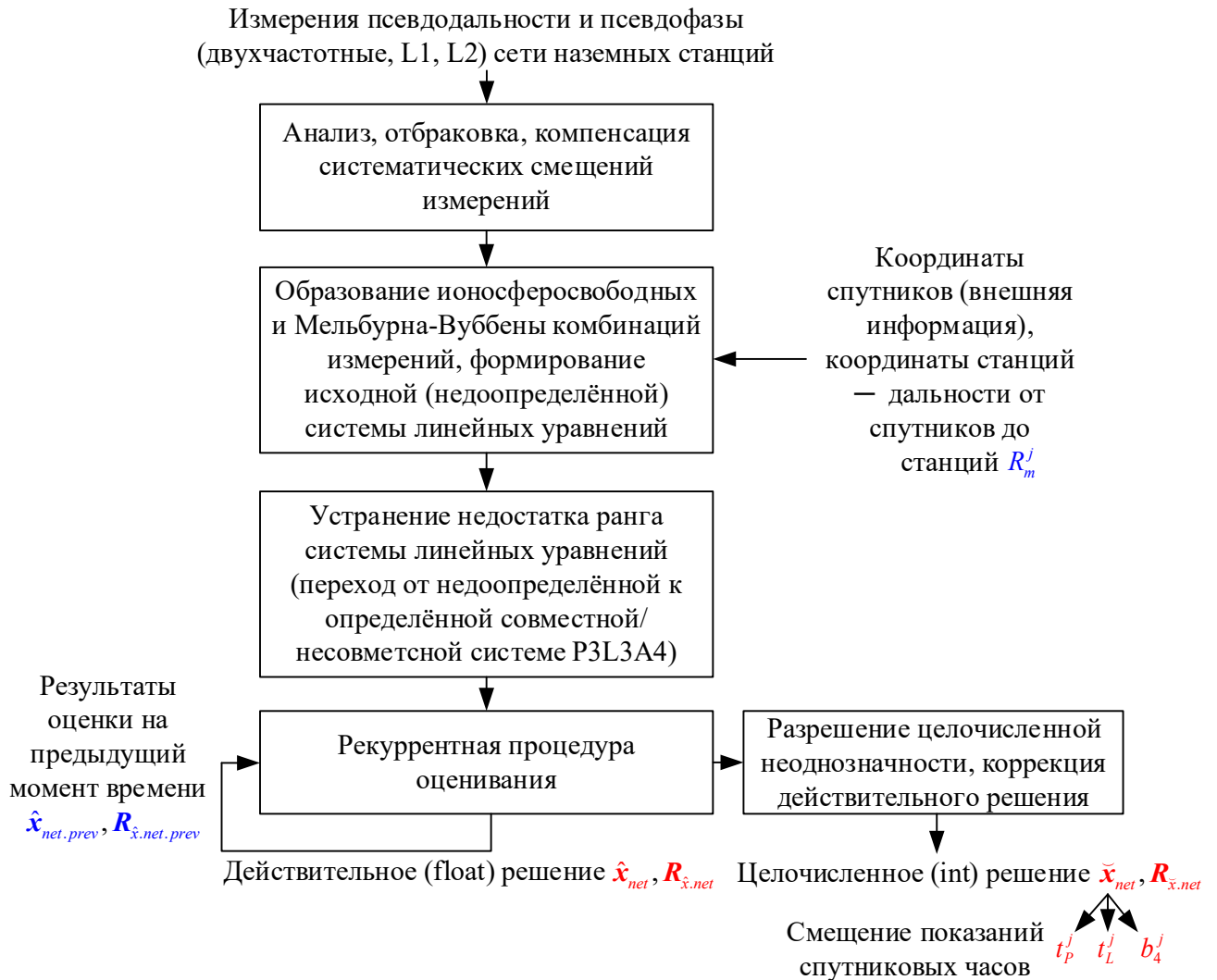
Рисунок Г.1 – Укрупнённая блок-схема алгоритма решения сетевой задачи целочисленного ВАМО
