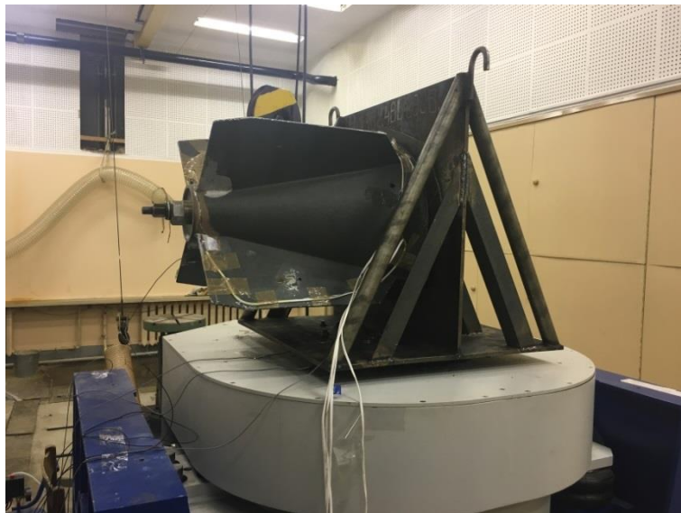
Рис. 2.15. Хвостовой отсек, закрепленный в приспособлении на вибростенде
