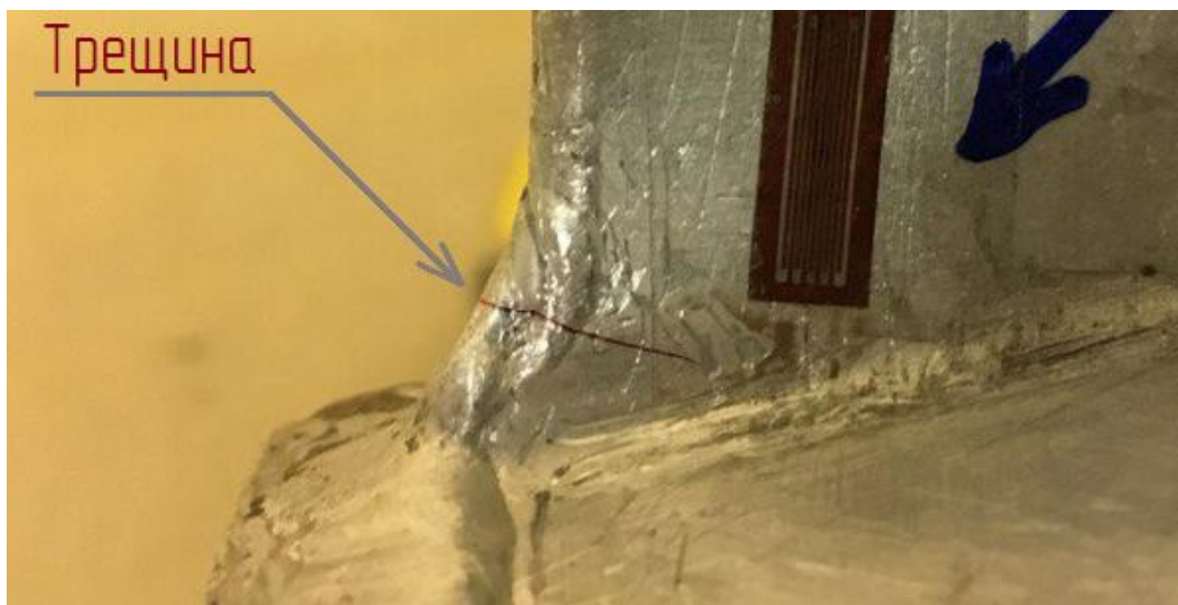
Рис. 3.25. Хвостовой отсек, закрепленный в приспособлении на вибростенде
