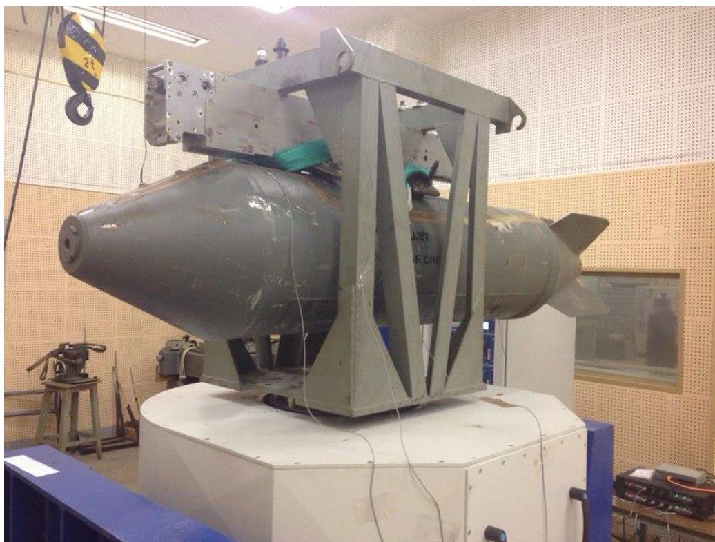
Рис. 1.4. Приспособление для вибрационных испытаний с закрепленным изделием
