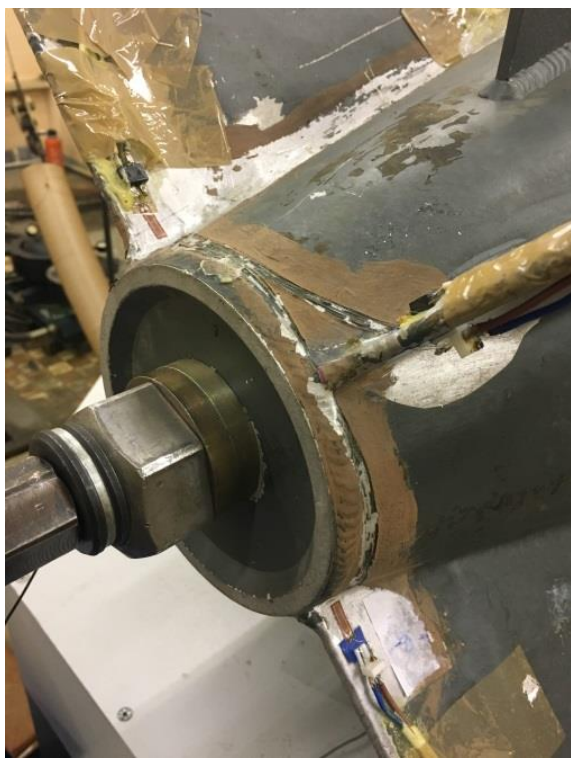
Рис. 2.21, а. Расположение тензорезисторов на отсеке
