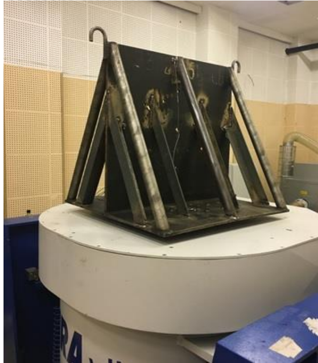
Рис. 2.11. Крепежное приспособление, установленное на вибростенде
