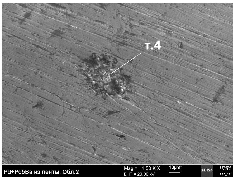
Рис. 4.11. Дефект в точке T.4 области 2 ленты Pd+Pd 5 Ba. Увеличение 1.50к X
