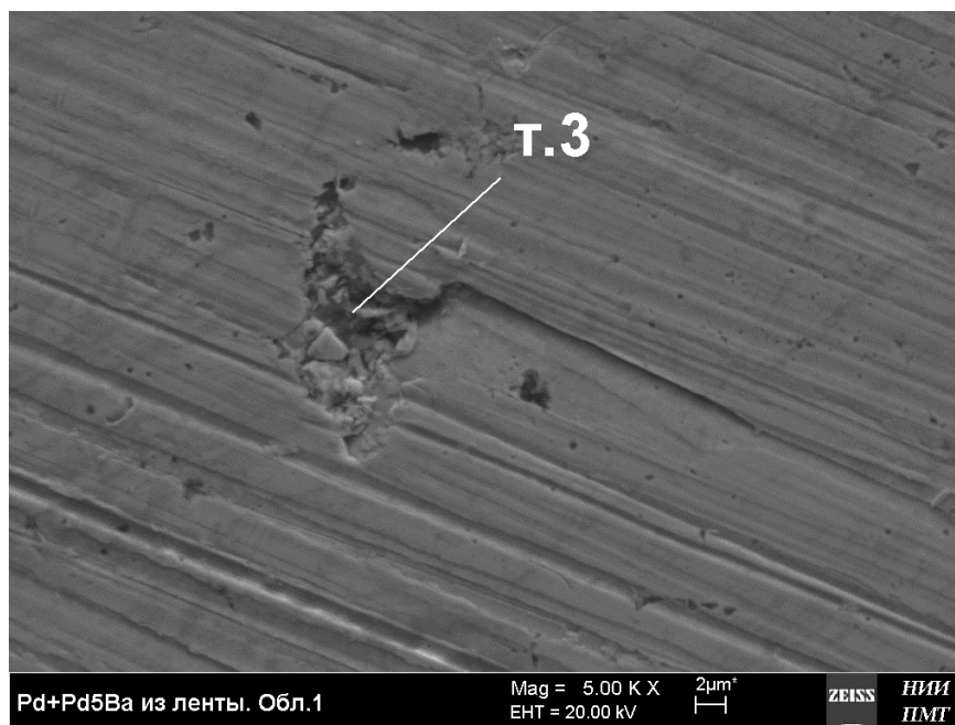
Рис. 4.8. Дефект в точке Т.3 области 1 ленты Pd+Pd 5 Ba. Увеличение 5.00к X
