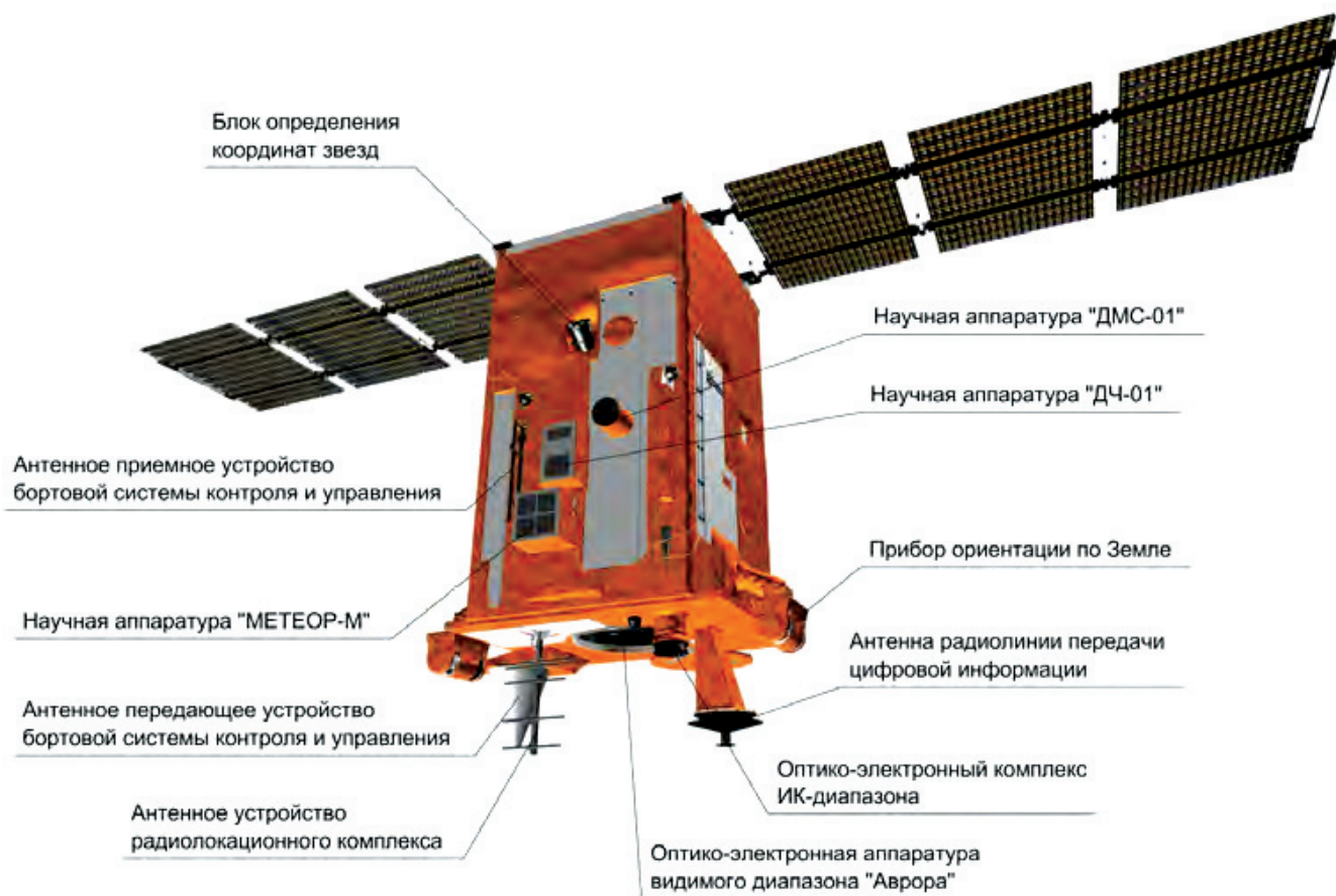
Рис. 4. Схема МКА «Аист–2Д»
