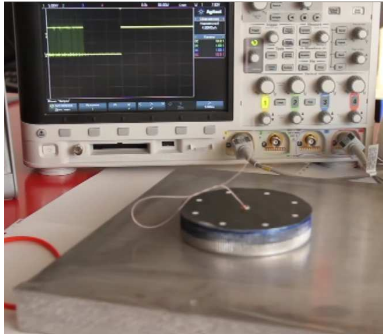
Рис. 27. Фотография реальной установки по определению времени отрыва диска от поверхности)
