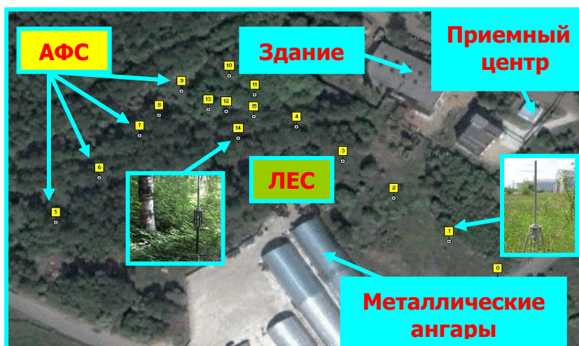
Рис. 2. Расположение на карте местности комплекса пеленгования на базе антенно-фидерной системы РДС-16К.
