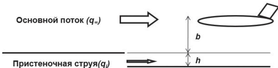
Рис. 1. Струйные границы: q_j < q_\infty для сплошной стенки; q_j > q_\infty для свободной границы
