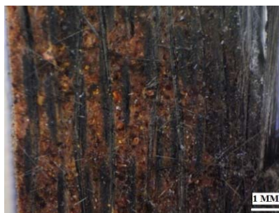
Рисунок 13 – Поперечное сечение после воздействия окислительной плазмы
