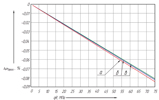
Рис. 9. Относительное изменение радиуса нейтрального слоя при упругой разгрузке с радиальным сжатием в зависимости от радиального сжатия при различных внутренних радиусах изгиба: а – r = 10 мм; б – r = 30 мм; в – r = 50 мм
