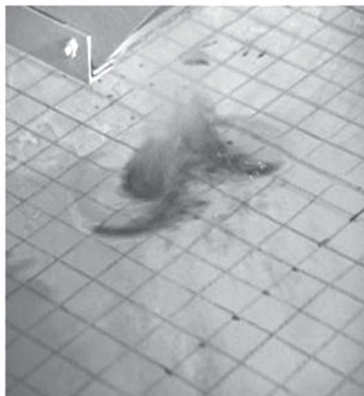
Рис. 2. Вихреобразование под прямоугольным входным устройством со скосом
