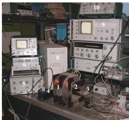
Рис.2. Фотография стенда для исследования воздействия импульсными электромагнитными полями на структуру магнитных носителей информации: 1 - катушки Гельмгольца, 2 - исследуемый образец, 3 - устройство позиционирования образца, 4 - электронный ключ, 5 - импульсный генератор с рабочей частотой в диапазоне от 0,1 до 20 кГц, 6 - источник питания, 7 - осциллограф, 8 - персональный компьютер, 9 - измеритель комплексного импеданса, 10 - измеритель магнитной индукции.
