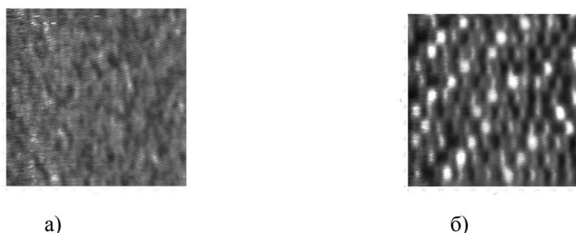
Рис.8. Картины магнитного рельефа в разных участках поверхностей дисков винчестера Hitachi Ultrastar A7K1000,1 ТВ после воздействия импульсным магнитным полем, а) первый диск, б) пятый диск.
