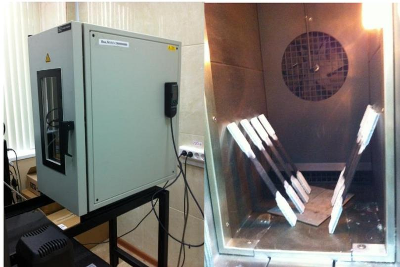
Рис. 4.2. Климатическая камера машины Инстрон.
