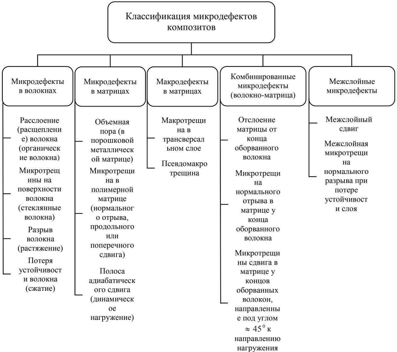
Рис. 1.1. Классификация микродефектов композитов.
