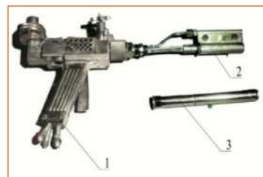
Рис. 1. Установка выполненная в виде горелки 1. Камера сгорания охлаждается покрытиями 2 (кварц, гранит, тешенит); 3 – козух [6]
