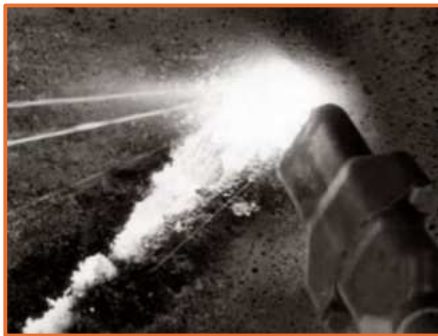
Рис. 11. Мощный термоинструмент со сдвоенной горелкой с d_{\text{к.}} = 5 \times 10^{-3} м для создания покрытий из вязких и пористых ( \epsilon = 30\% ) природных материалов (продукты извержения вулканов, зола, шлак, туф) методом плавления
