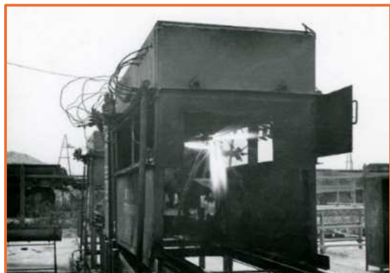
Рис. 3. Огневой бокс поточной линии с четырьмя машинными керосино-кислородными термоинструментами, работающие в автоматическом режиме, для напыления изделий природными материалами
