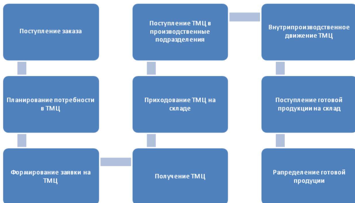
Рис. 2. Схема движения материального потока при логистическом управлении производством на предприятиях авиадвигателестроения.
