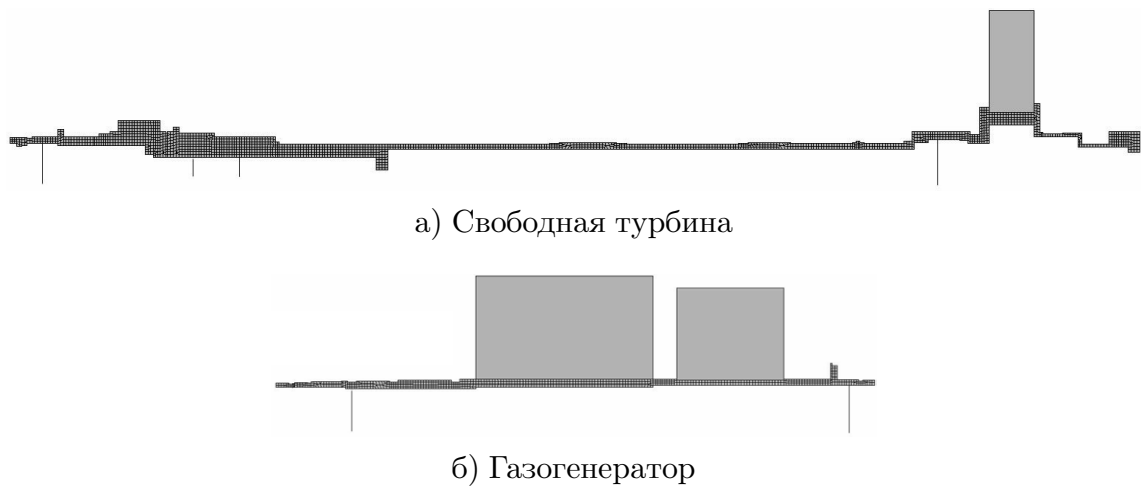
Рис. 4.13. Трёхмерная конечно-элементная модель роторной системы
