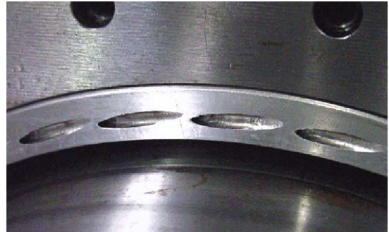
б) Фотография входного кольца закрутки
