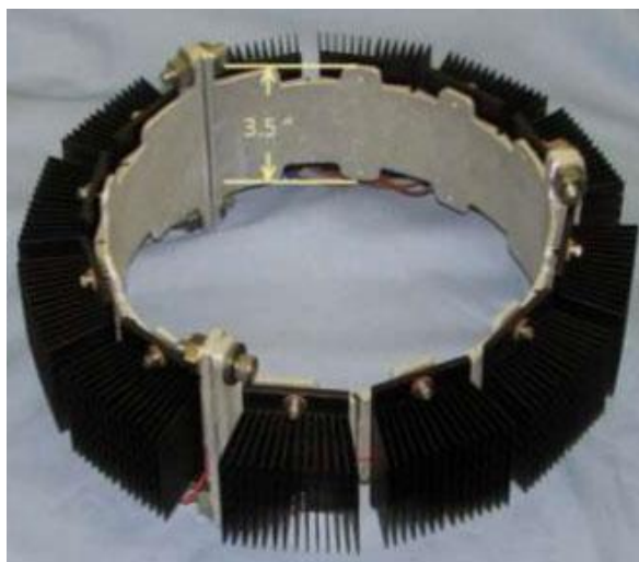
Рис. 1.14 Энергоустановка разработанная в [55] которая создает электрическую энергию за счет изменения температуры.
