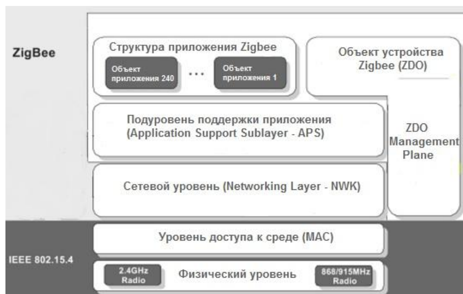
Рис. 1.2 Стек протокола Zigbee [10]
