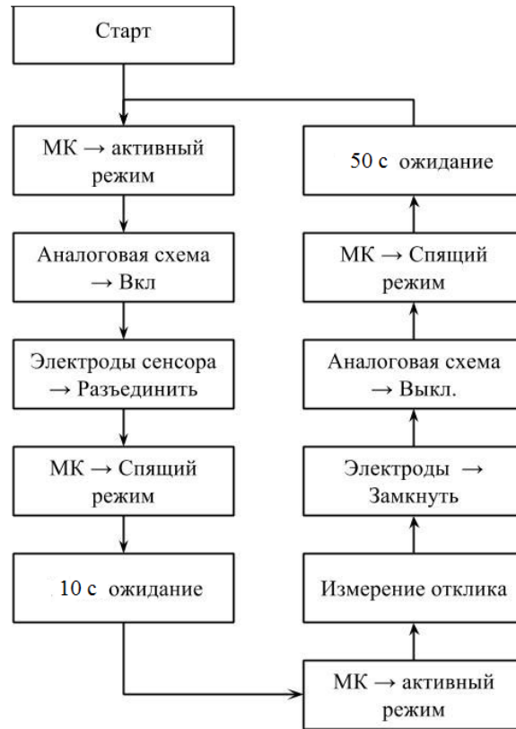
Рисунок 4.4 - алгоритм работы автономного беспроводного датчика CO
