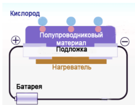
Рис. 1.5 Металло-оксидный полупроводниковый датчик при ионизации кислорода [19]
