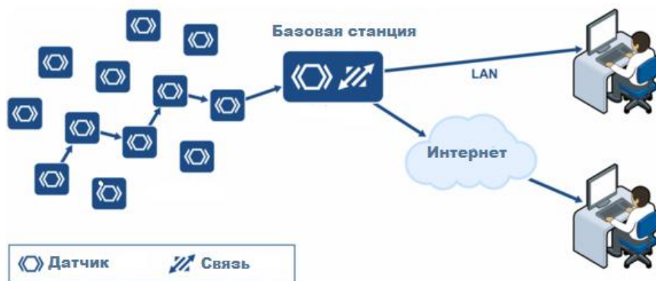
Рис.1.1 Структура одной беспроводной сенсорной сети [4]
