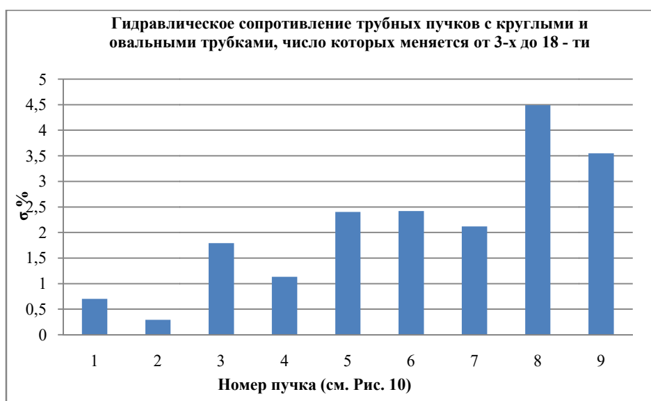
Рис. 11 Изменение гидравлического сопротивления трубчатых пучков, отличающихся формой (цилиндр или эллипс), количеством трубок в одном пучке и их ориентацией относительно оси ГТД
