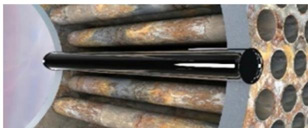
Рис. 1. Место соединения трубы с трубной решеткой
