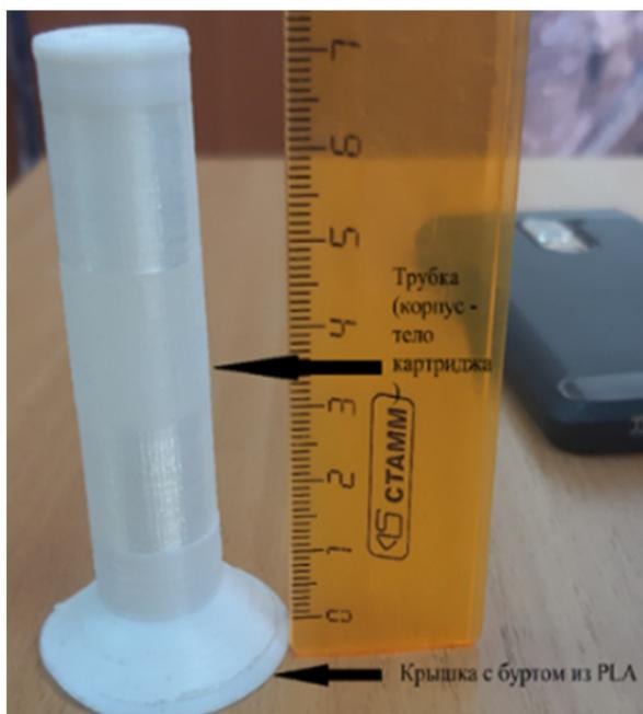
Рис. 11. Опытный образец, сделанный на 3D-принтере
