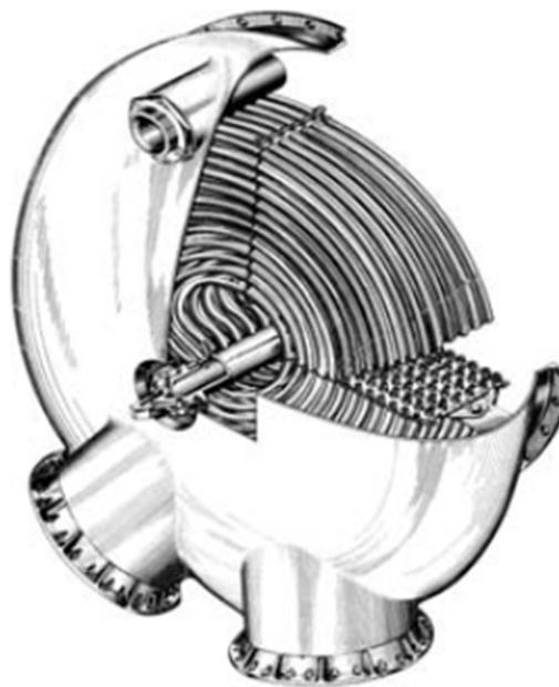
Рис. 2. Испаритель азота двигателей РД107 и РД108
