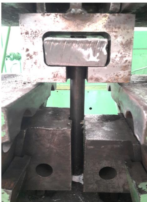
Рис. 16. Крепления образца в разрывной машине
