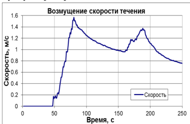
Рис. 3. Возмущение скорости в начальном сечении, созданное последовательным пуском двух насосных агрегатов (НА)
