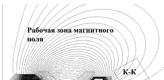
Рис. 5 Конфигурация силовых линий рабочей зоны магнитного поля
