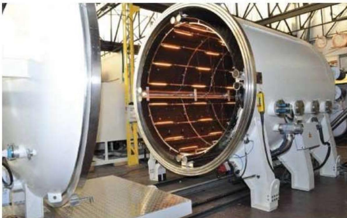
Рисунок 2.5 – Экспериментальная установка с размещением галогенных ламп накаливания
