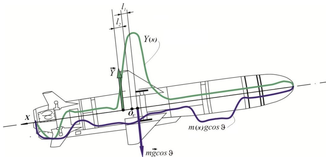
Рисунок 4 – Нормальные составляющие распределенных сил ПКР и их результирующие
