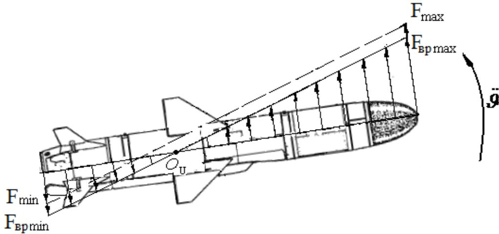
Рисунок 5 – Результирующие силы поступательного и вращательного движения ракеты
