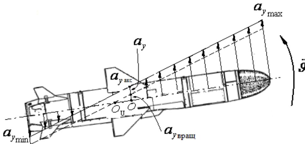
Рисунок 1 – Распределение показаний акселерометров по длине ракеты
