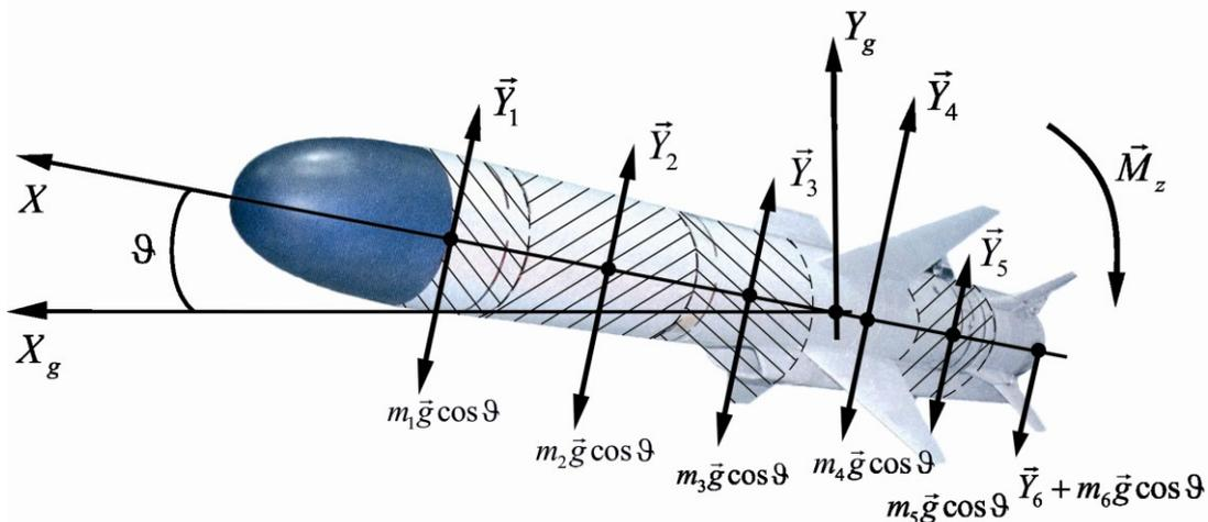
Рисунок 2 – Действие нормальной силы и нормальной составляющей силы тяжести на отдельные части ракеты
