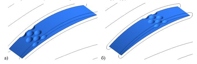
Рис. 3. Лопатки компрессорной решетки с углублениями: а) крайнее переднее положение углублений; б) крайнее заднее положение углублений
