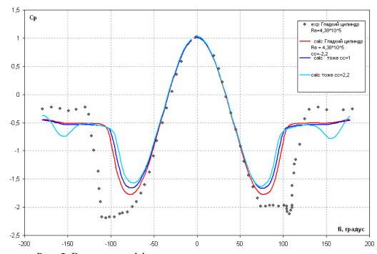
Рис. 5. Влияние коэффициента кривизны потока на результаты расчета
