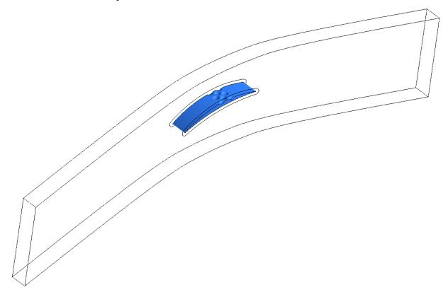
Рис. 2. Внешний вид расчетной области лопатки компрессора
