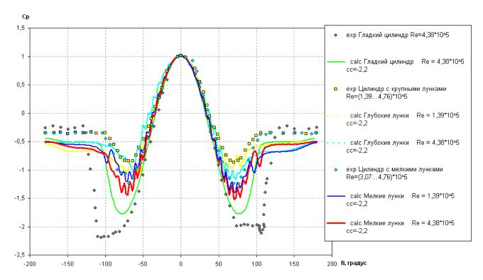
Рис. 6. Расчет обтекания цилиндров.
