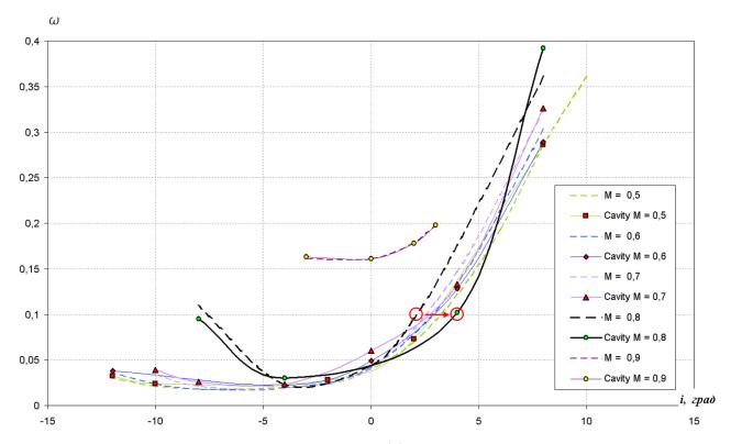
Рис. 10. Зависимость коэффициента ω от угла атаки
