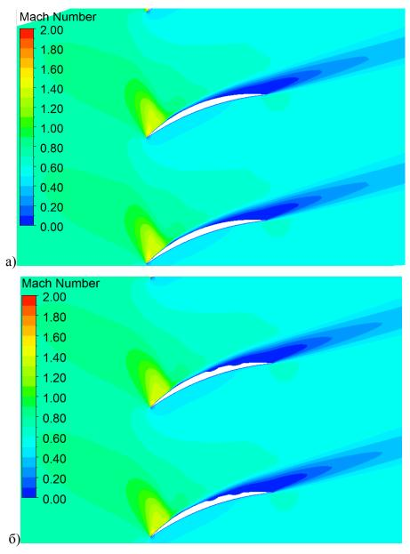
Рис. 8. Распределение чисел Маха в межлопаточном канале для: а) гладкого профиля; б) для профиля с оптимальными геометрическими параметрами углублений
