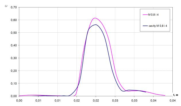
Рис. 9. Распределение коэффициента ω за решеткой для гладкого профиля и профиля с оптимальной геометрией углублений
