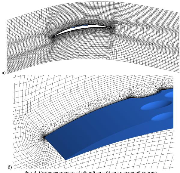
Рис. 4. Сеточная модель: а) общий вид; б) вид у входной кромки
