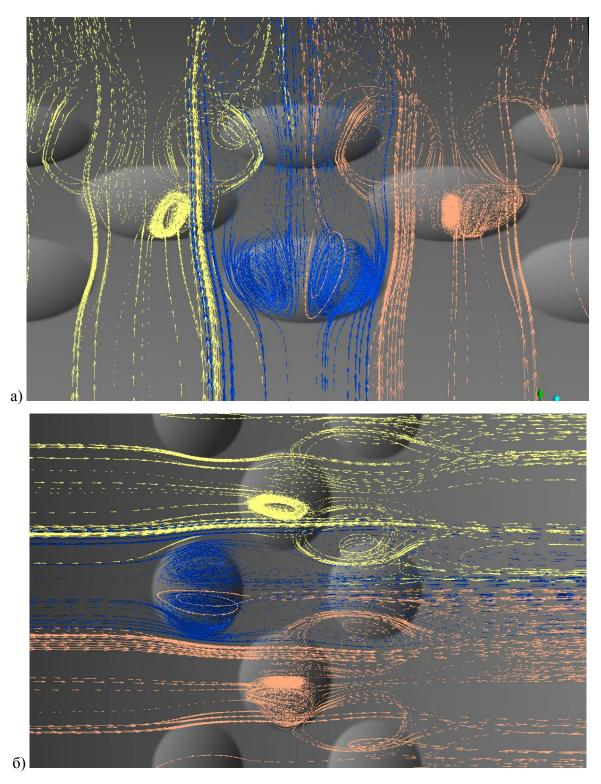
Рис. 11. Визуализация потока в районе углублений: а) вид на лопатку по потоку; б) вид на лопатку сверху (поток течёт слева на право)
