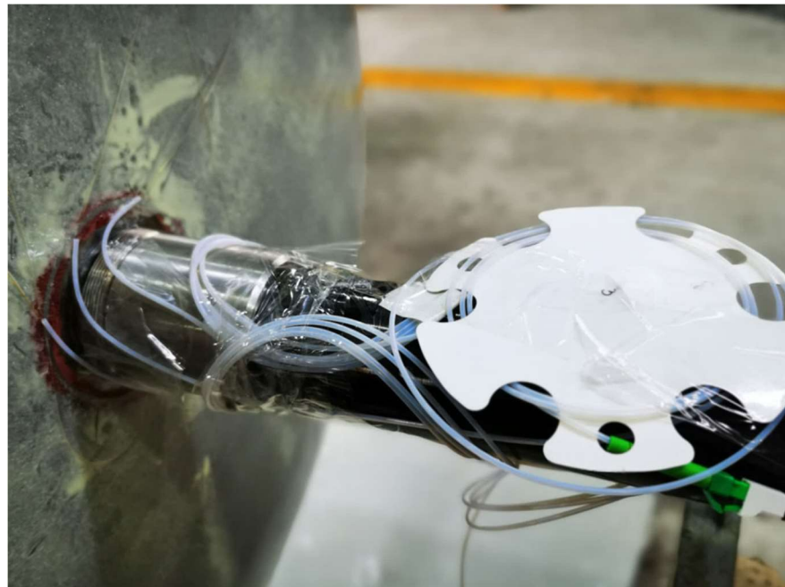
Рисунок 3.28 – Расположение выводов ВОД на фланце изделия
