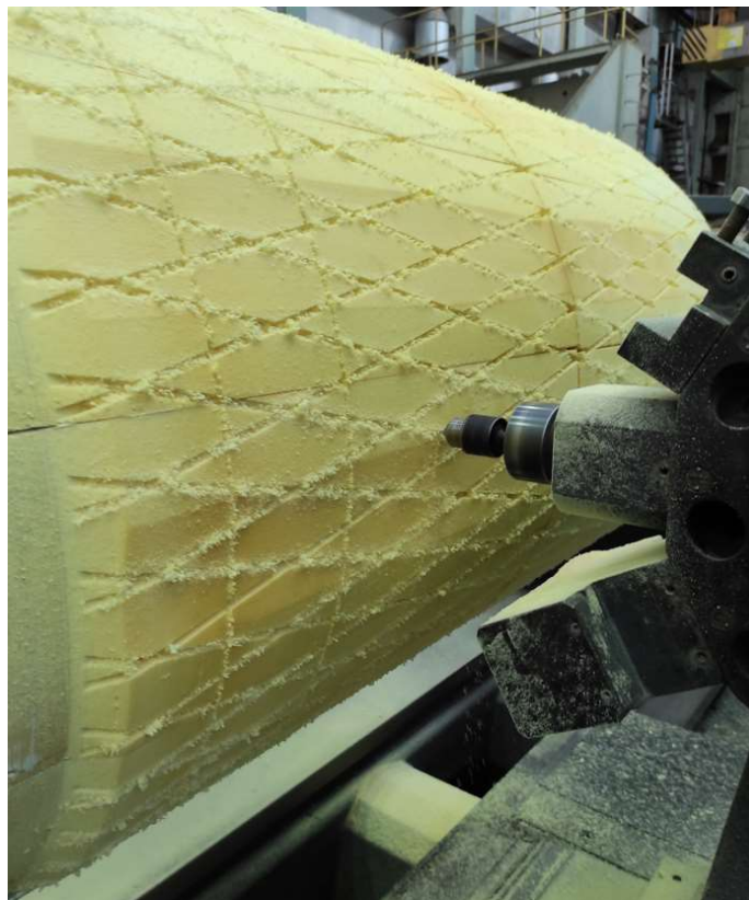
Рисунок 3.5 – Механическая обработка пенопласта
