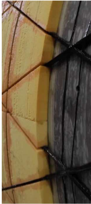
Рисунок 3.15 – Картина проникновения связующего в формообразующий пенопласт в процессе «мокрой» намотки
