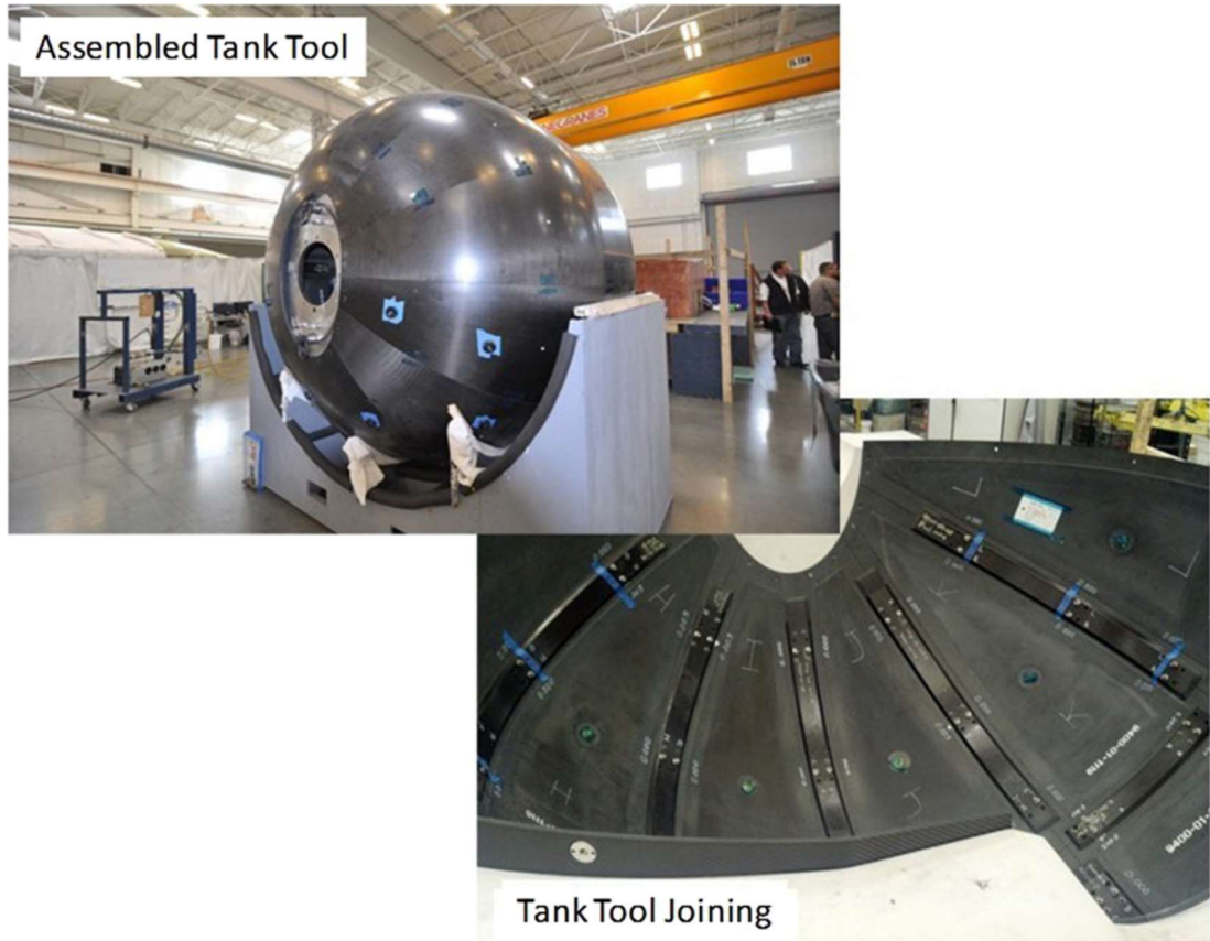
Рисунок 1.18 – Разборная металлическая оправка для бака SLS диаметром 2.4 м [165]
