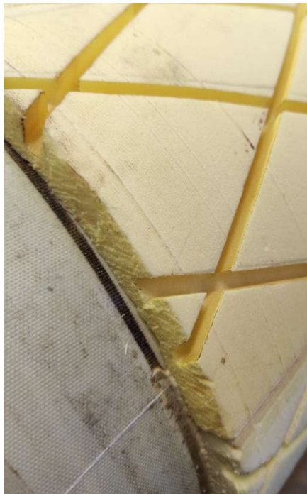
Рисунок 3.15 – Картина проникновения связующего в формообразующий пенопласт в процессе «мокрой» намотки
