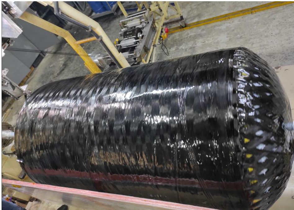
Рисунок 3.7 – Процесс мокрой автоматизированной намотки обшивки бака
