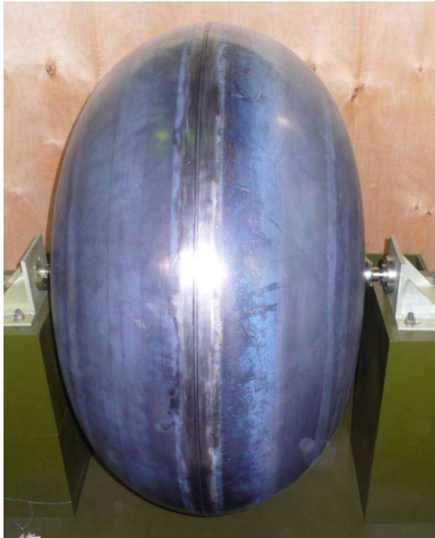
Рисунок 1.2 – Металлический лайнер из титанового сплава, полученный при помощи аргонно-дуговой сварки
