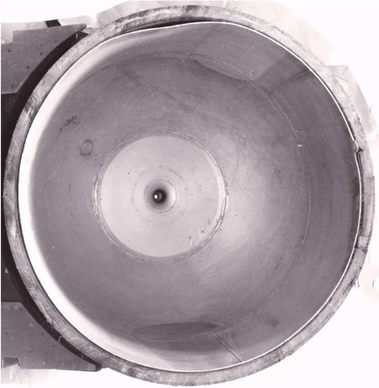
Рисунок 3.20 – Форма потери устойчивости герметизирующего лайнера
