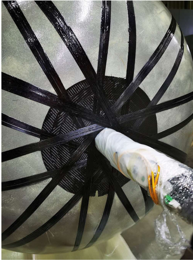
Рисунок 3.29 – Защита выводов ВОД салфетками в процессе намотки
