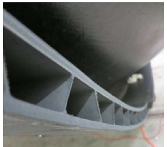
Рисунок 1.19 – Ручная сборка силовой оболочки и её готовый вид [165]
