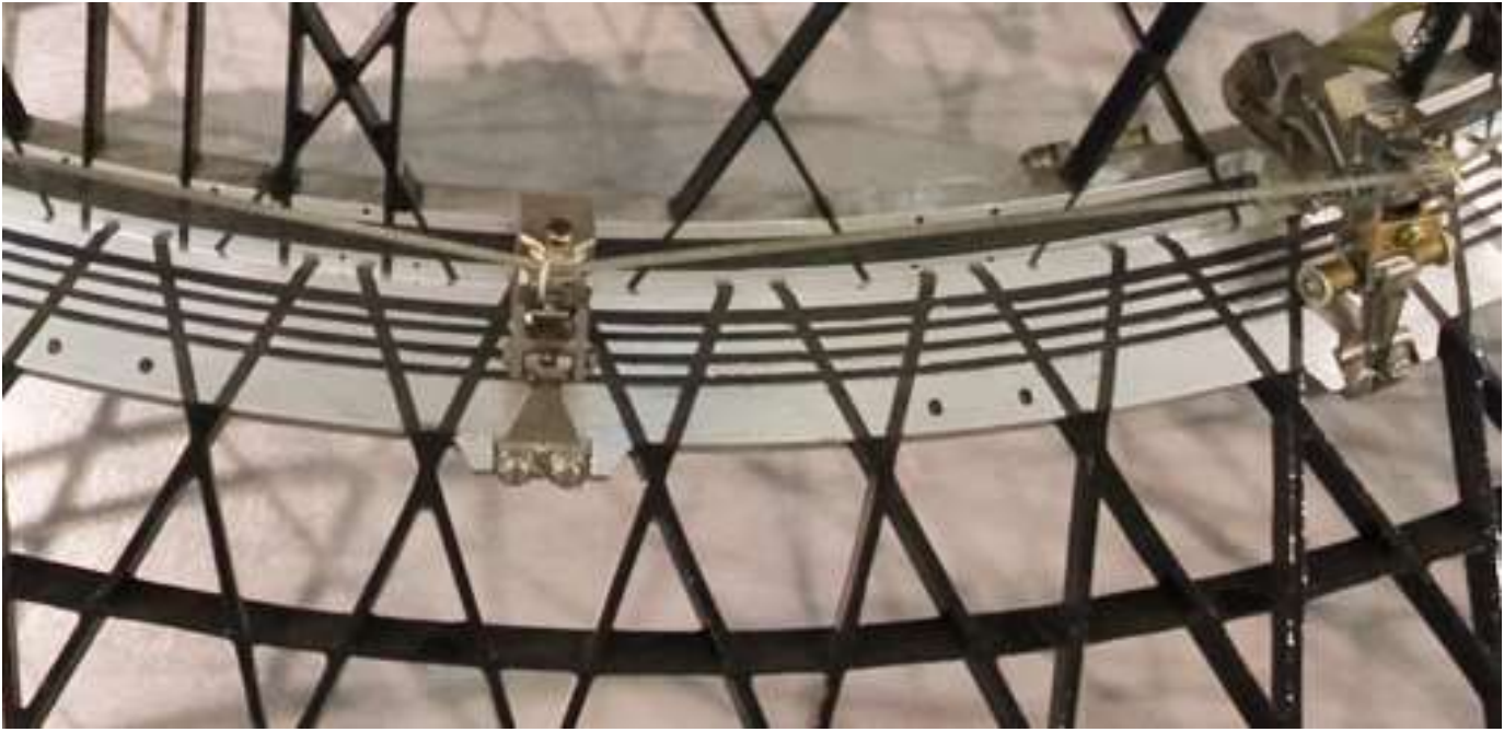
Рисунок 6.1 – Металлические шпангоуты с предварительно выполненными пазами, в которые осуществляется намотка сетчатой структуры
