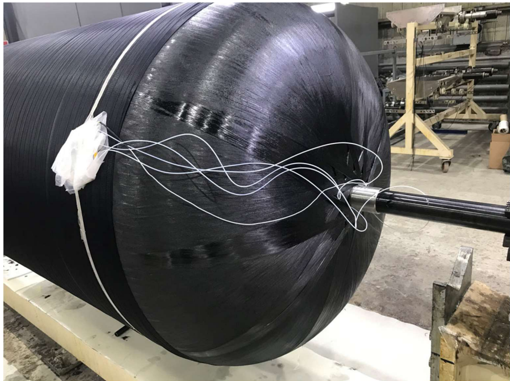
Рисунок 3.30 – Перенос выводов ВОД в пассивную зону
