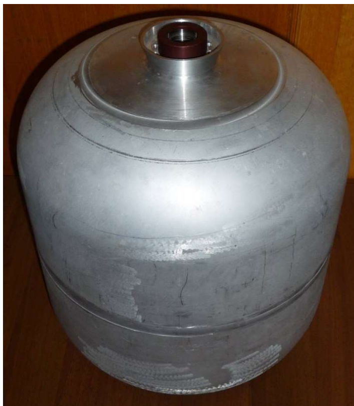
Рисунок 1.3 – Металлический лайнер, полученный сваркой трением
