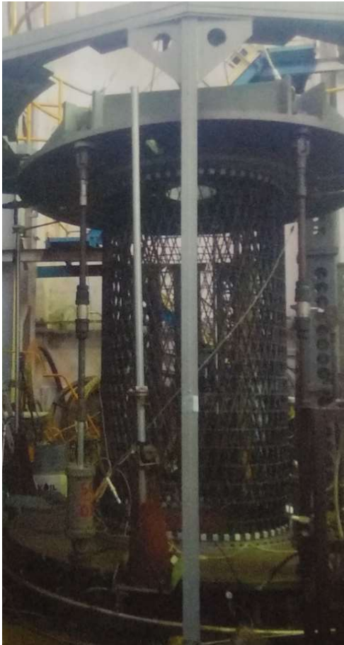
Рисунок 1.14 – Статические испытания сетчатого отсека
