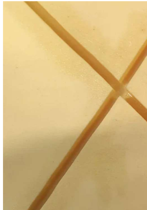
Рисунок 3.15 – Картина проникновения связующего в формообразующий пенопласт в процессе «мокрой» намотки
