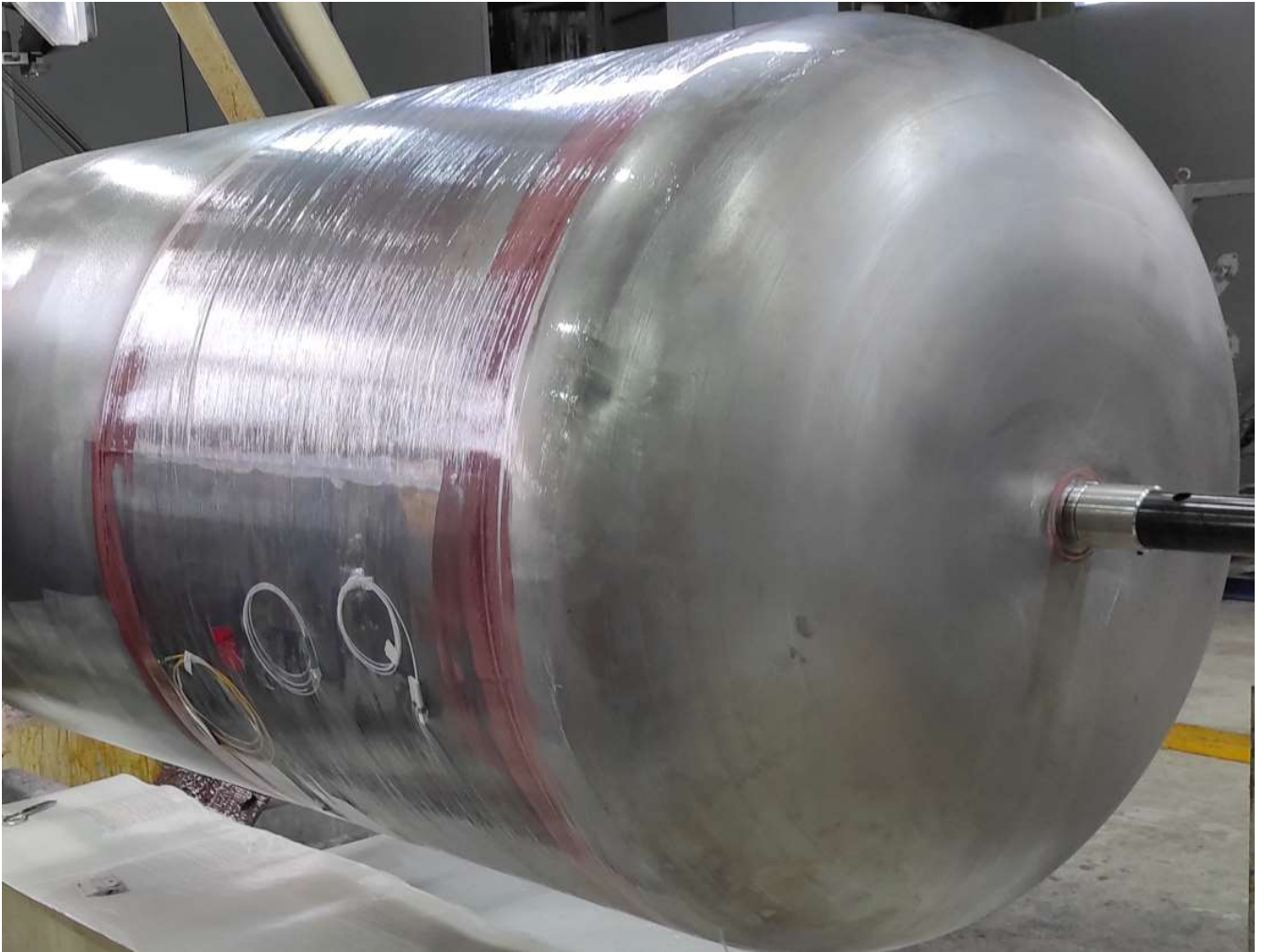
Рисунок 3.3 – Установленные датчики защищены временной стретч-плёнкой до начала процесса намотки силовой оболочки бака
