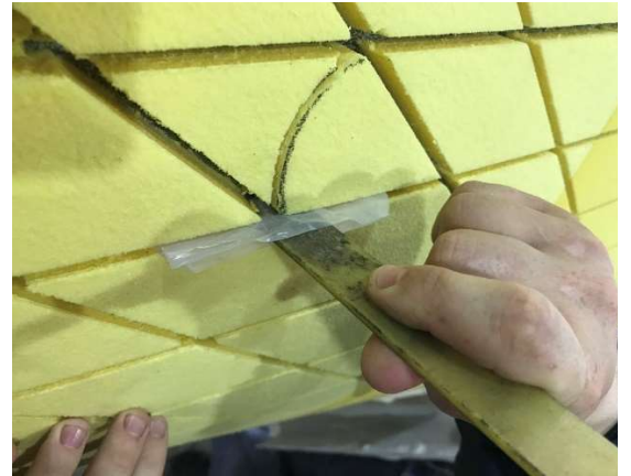
Рисунок 3.33 – Клеевая подготовка (а) и укладка (б) волокна в пазы оснастки посередине толщины ребра.
