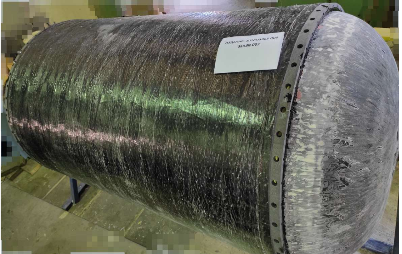
Рисунок 3.10 – Заготовка бака с отторцованными шпангоутами и выполненными штифто-шпилечными отверстиями
