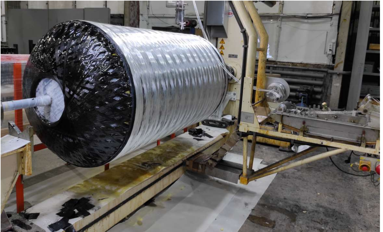
Рисунок 3.8 – Заготовка в технологической «рубашке» перед термообработкой
