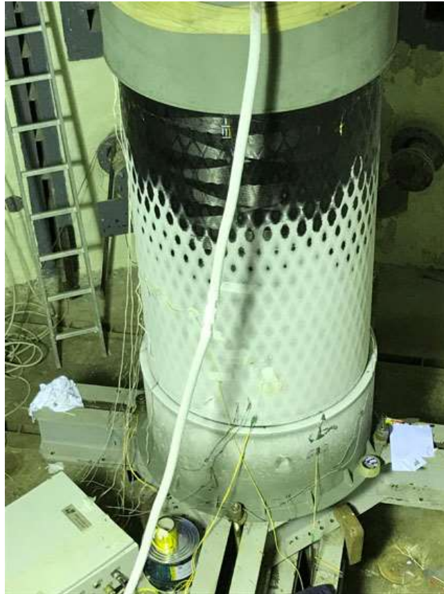
Рисунок 5.8 – Сетка холода на наружной обшивке бака
