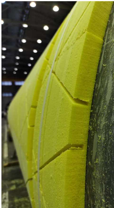
Рисунок 3.12 – Использование пенопласта в качестве формообразующего материала
