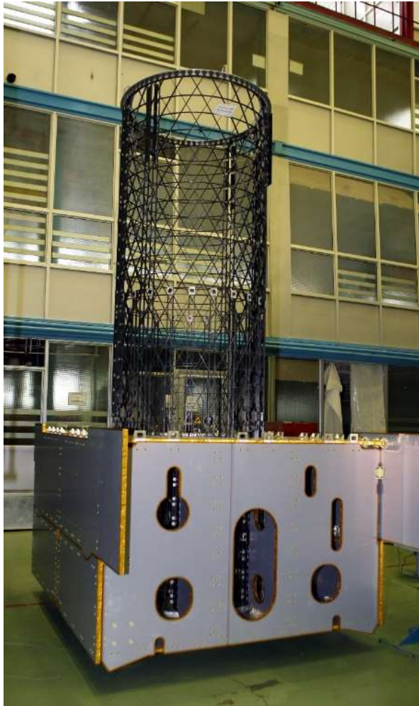
Рисунок 1.12 – Сборка корпуса КА Экспресс-2000
