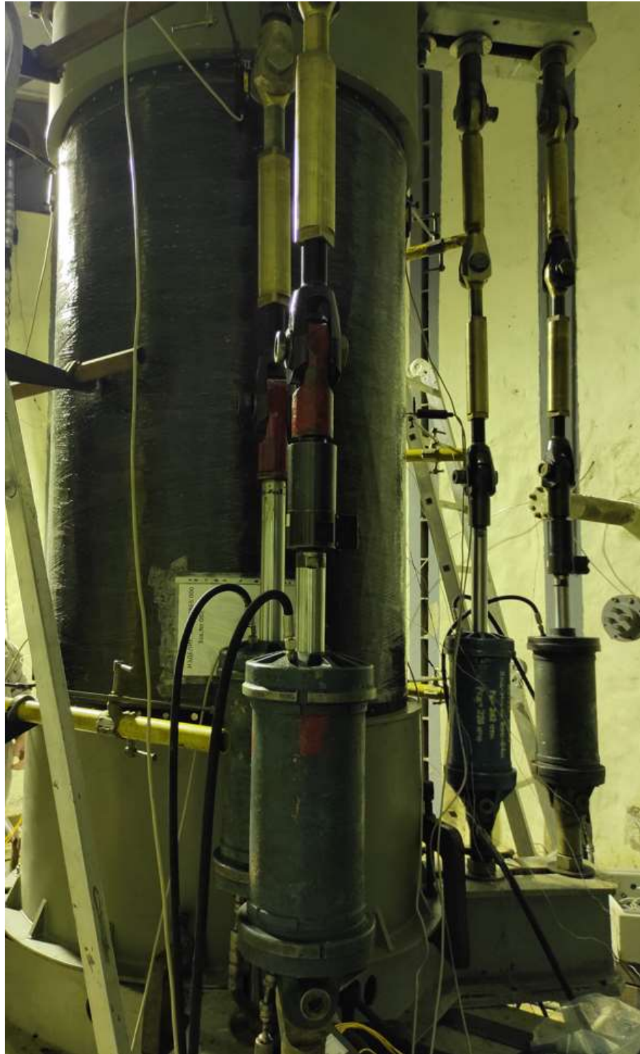
Рисунок 5.11 – Модельный бак и испытательная оснастка перед началом испытаний
