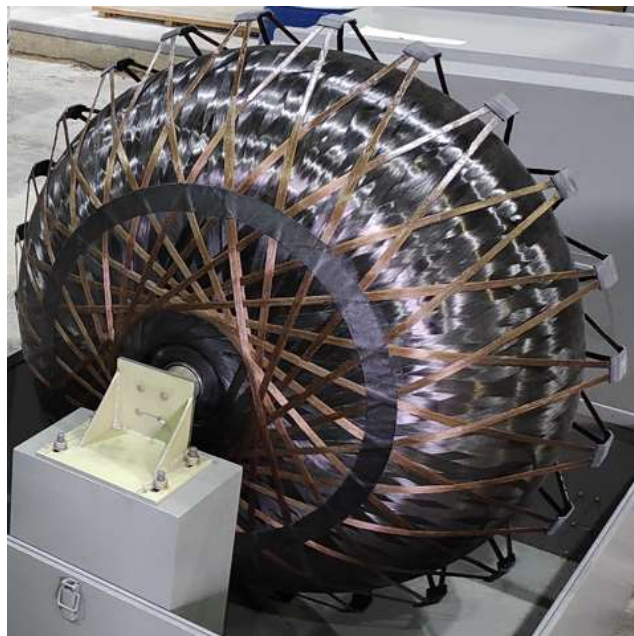
Рисунок 1.6 – Варианты систем крепления баллонов давления: фланцевое (а), при помощи силовой юбки (б), при помощи системы «строп» (в)
