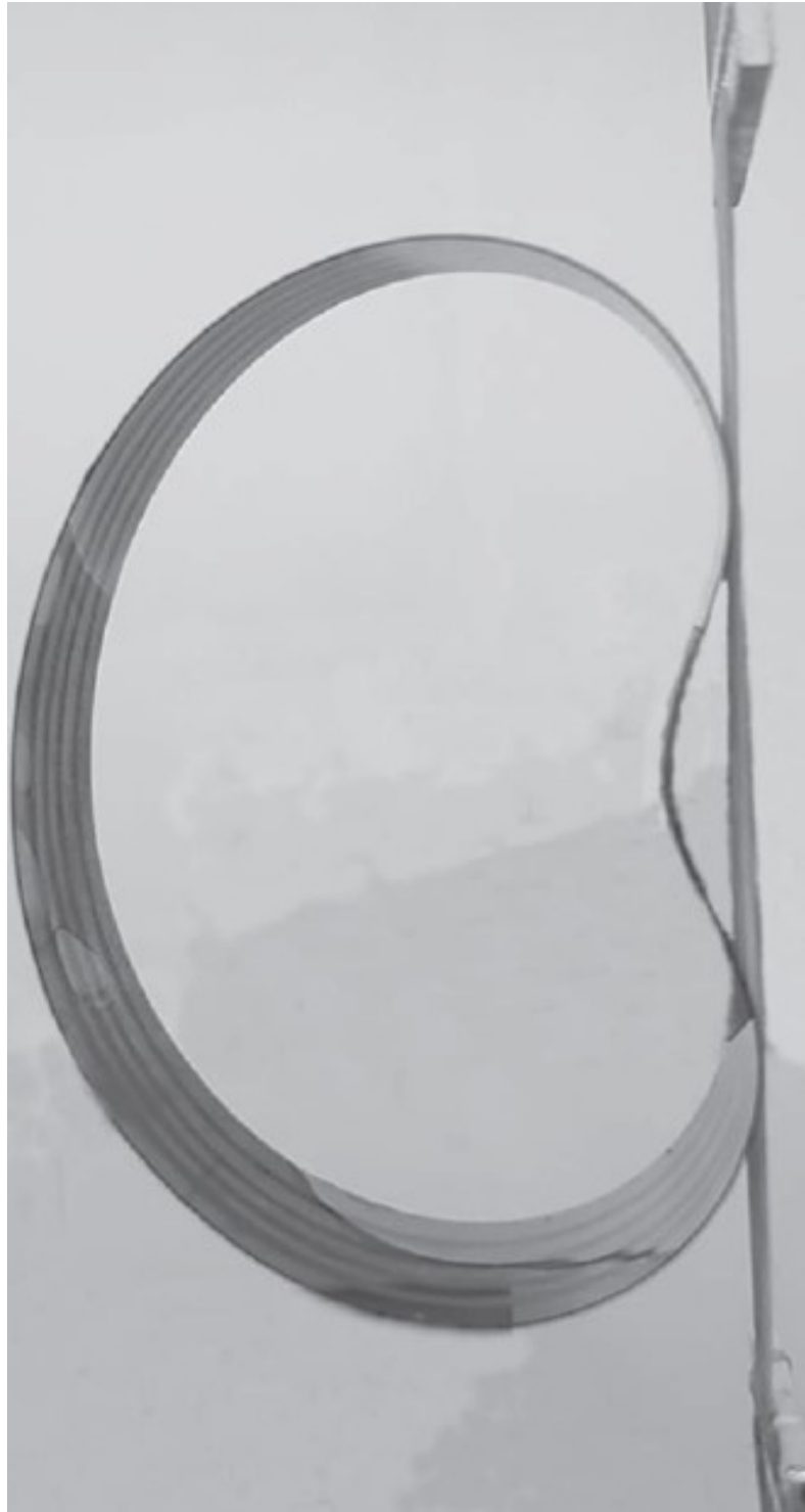
Рисунок 1.5 – Деформирование и потеря устойчивости тонкостенного лайнера от натяжения системы гибких нитей
