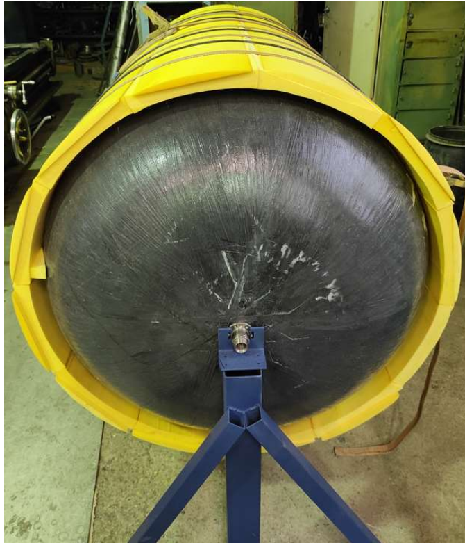
Рисунок 3.4 – Укладка пластин из конструкционного пенопласта
