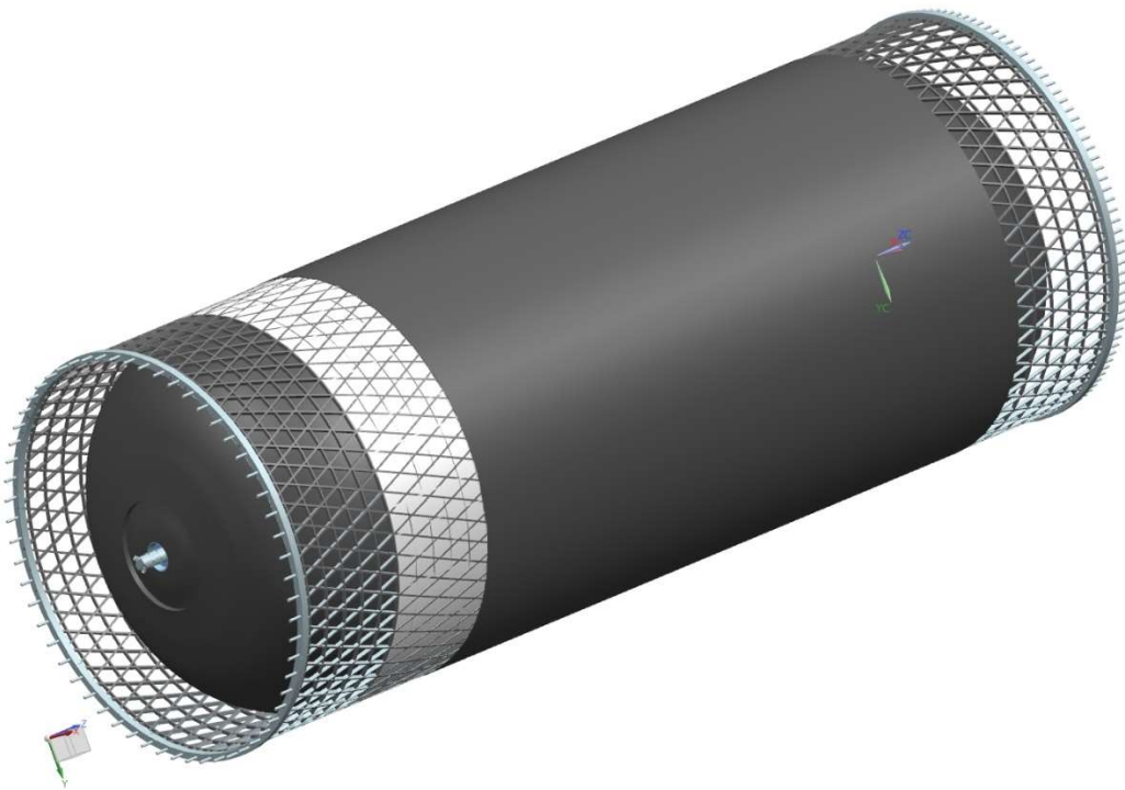
Рисунок 6.2 – 3D модель полноразмерного топливного бака
