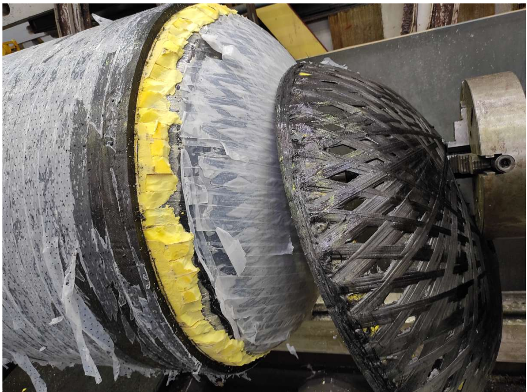
Рисунок 3.9 – Удаление «ложных» технологических разворотных днищ
