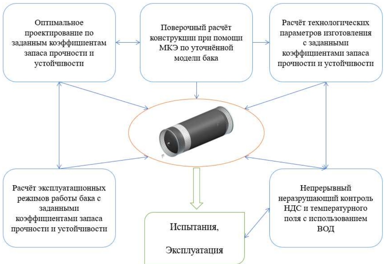
Рисунок 6.11 – Комплексная модель оценки прочности металлокомпозитного криогенного топливного бака
