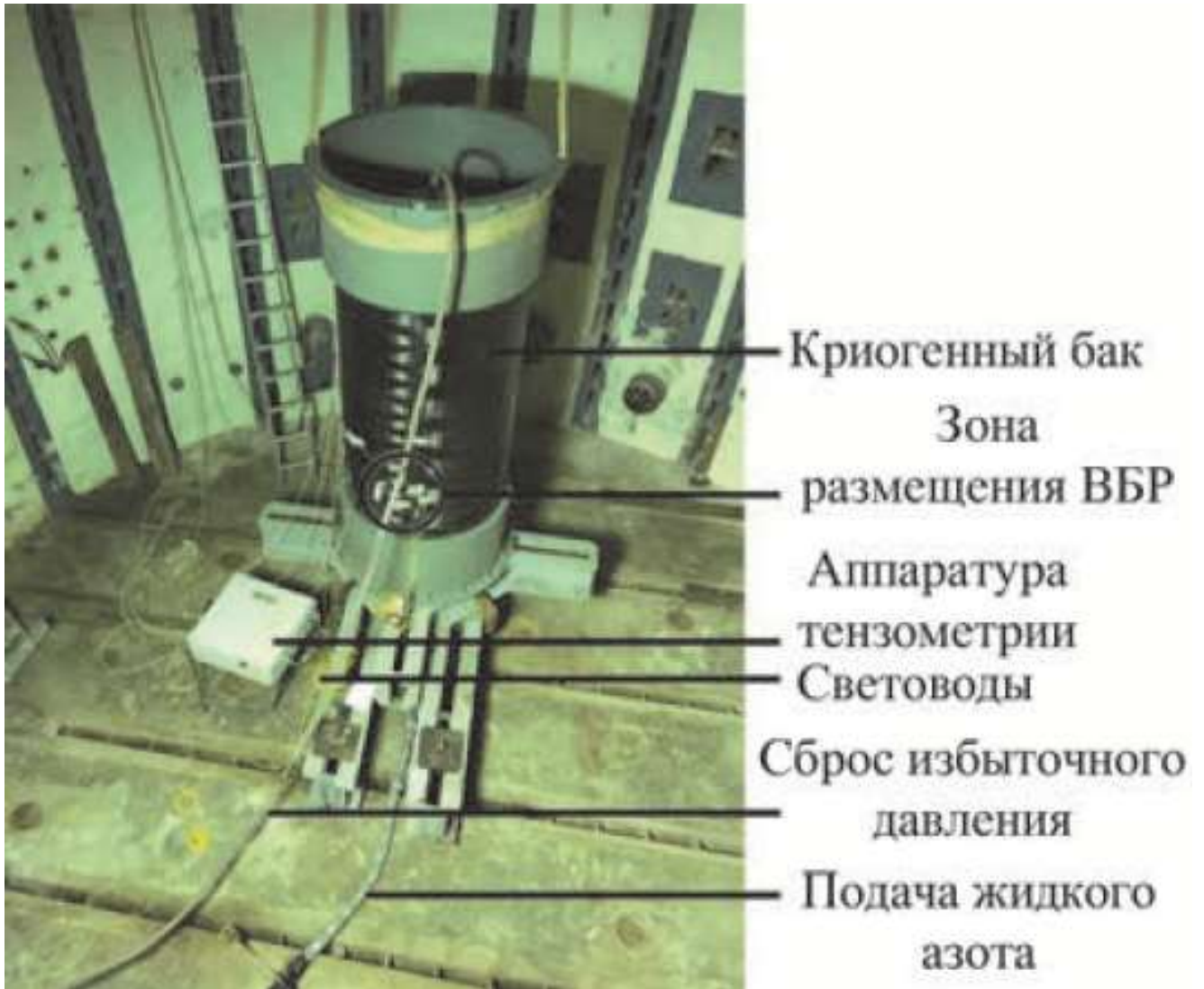
Рисунок 5.14 – Модельный криогенный металлокомпозитный топливный бак в испытательном комплексе в процессе криостатических испытаний
