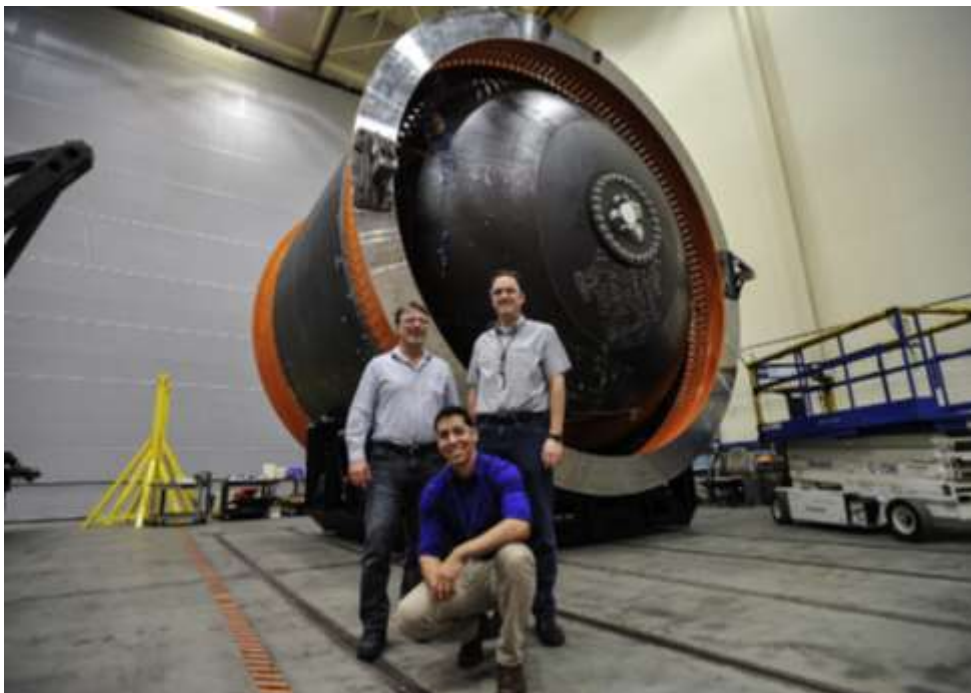
Рисунок 1.17 – Внешний вид готового бака диаметром 5.5 м [165]
