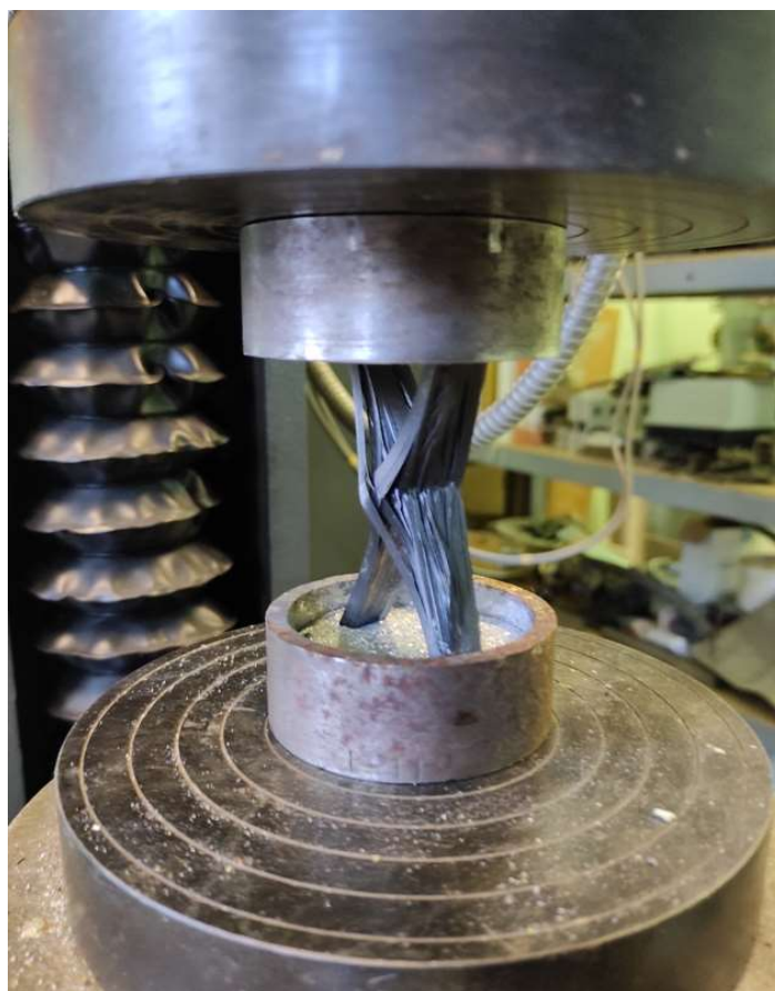
Рисунок 3.14 – Испытания образцов рёбер на механическую прочность
