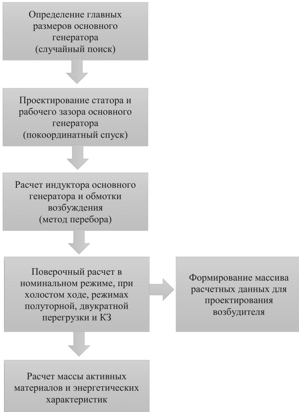
Рисунок 3.12 – Блок-схема локального алгоритма электромагнитного расчета основного генератора
