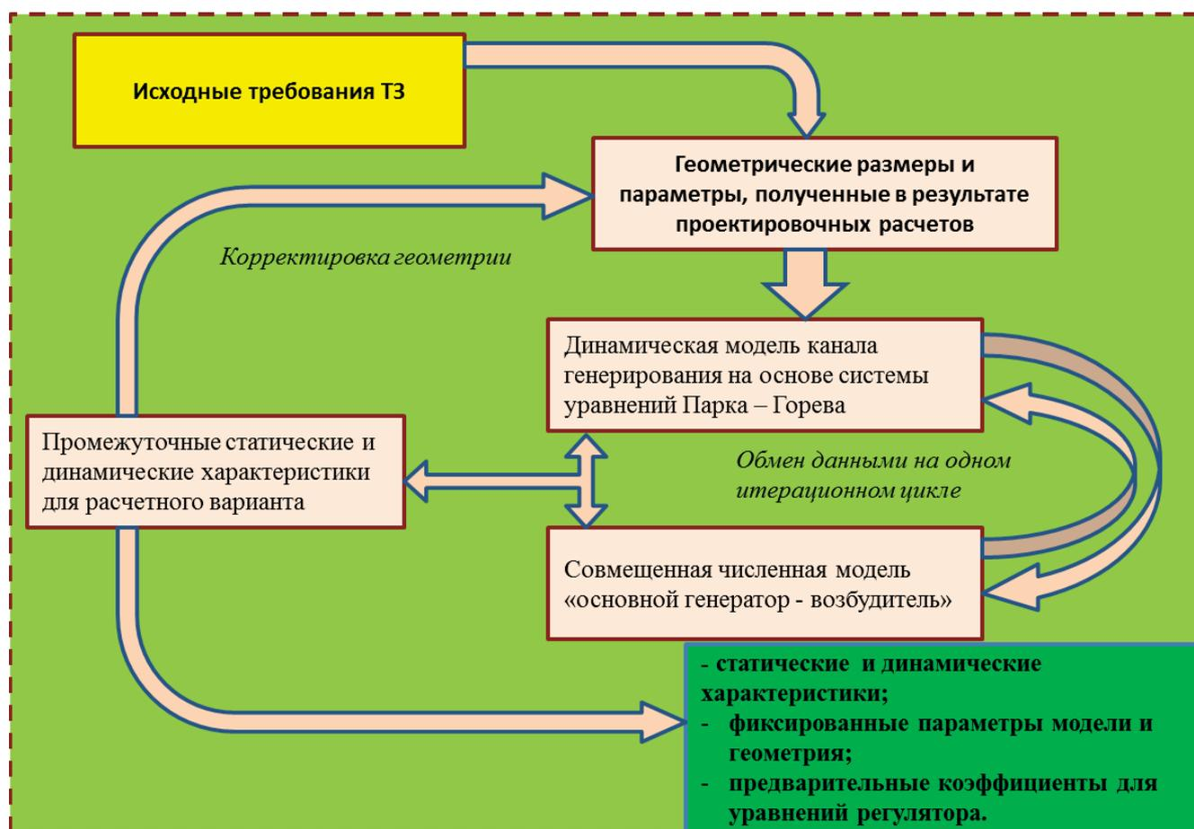
Рисунок 2.17 – Структурная схема методики имитационного моделирования режимов работы синхронного генератора
