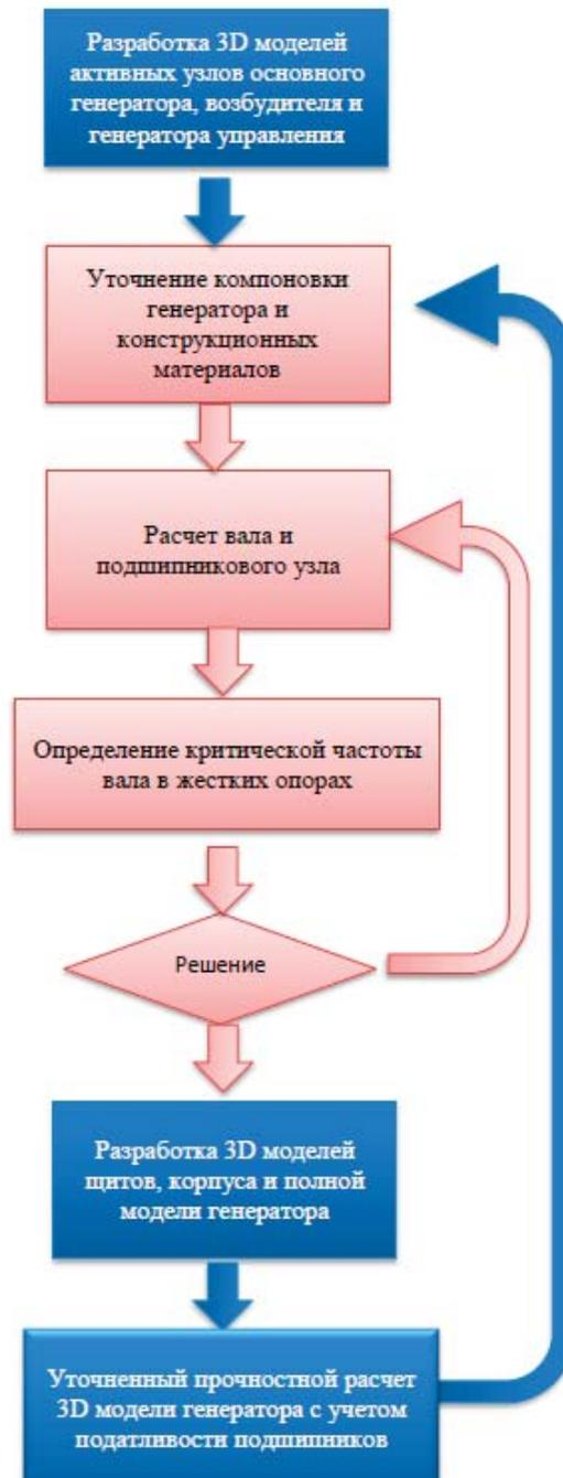
Рисунок 2.20 – Блок-схема алгоритма оптимального проектирования конструкции генератора
