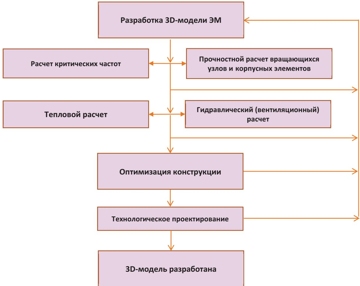
Рисунок 3.14 – Блок-схема локального алгоритма 3D-моделирования генератора
