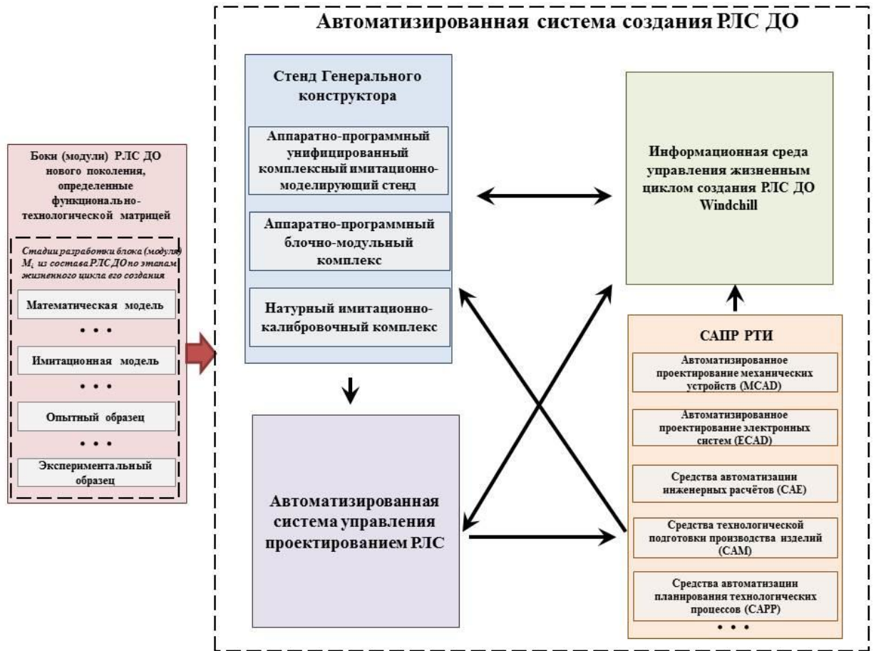
Рис. 4.1.1 Аппаратные и информационно-программные средства АСС
