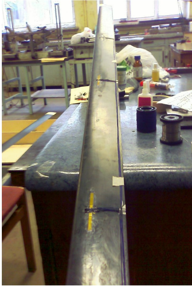
Рисунок 4.2. Лопать с тензометрическими датчиками
