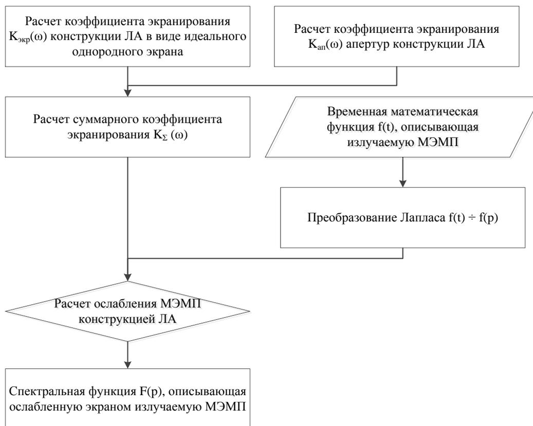
Рисунок 2 – Алгоритм расчета
