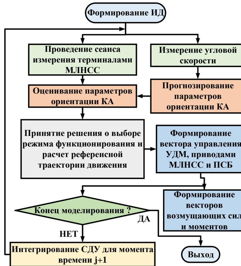
Рисунок 3.1 – Схема моделирования процесса функционирования интегрированной системы определения ориентации
