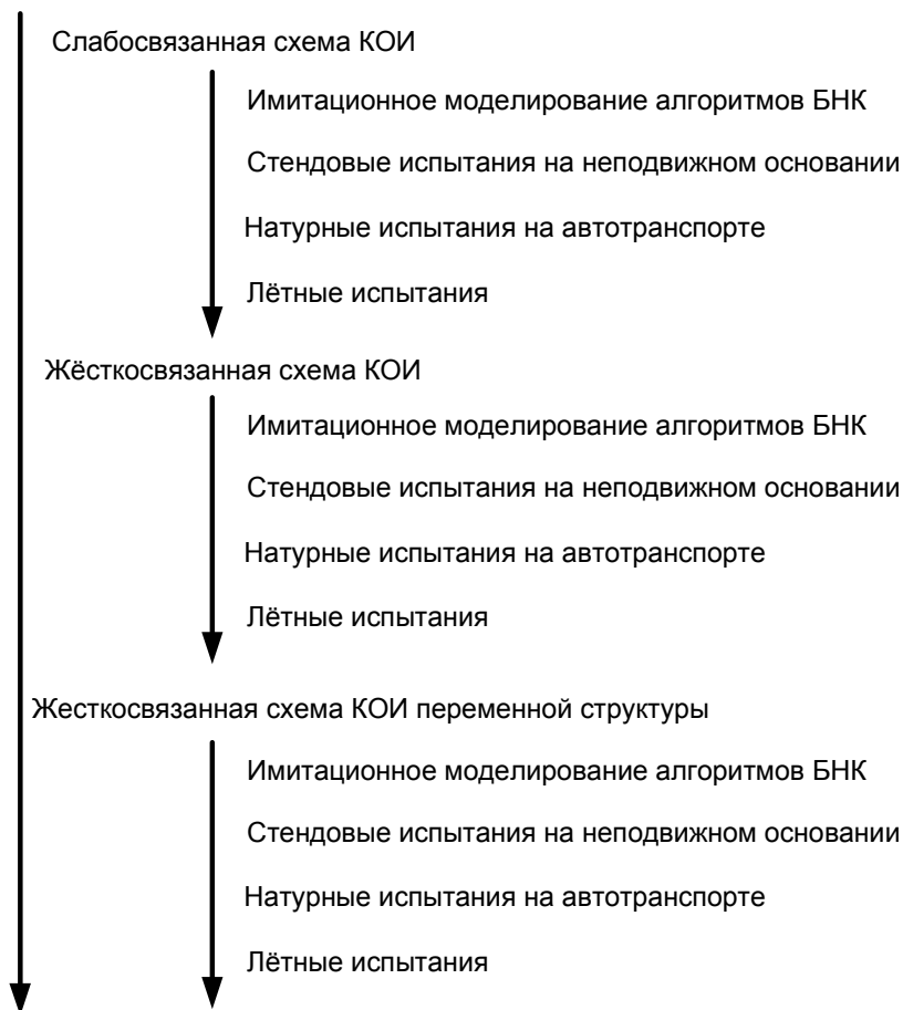
Рисунок 4 – Общая последовательность отладки и испытаний алгоритмов, программного и аппаратного обеспечения БНК.
